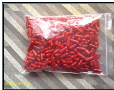
ภาพที่ 13 แคปซูลสำหรับใส่ \text{Cr}_2\text{O}_3
