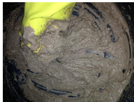
รูปที่ 3-6 การกวนผสมให้เป็นเนื้อเดียวกัน
