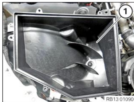
ทำความสะอาดส่วนล่างของปลอกที่กรองอากาศ 1
