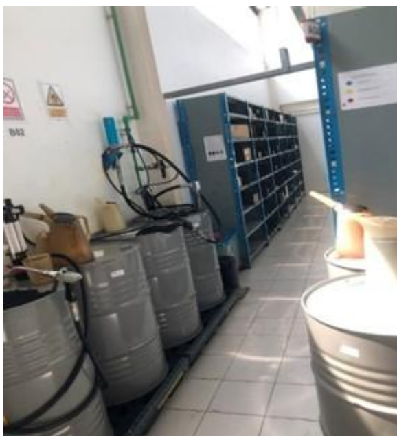
รูปที่ 4.7 การวางถังน้ำมันเครื่องและมีป้ายแจ้งเตือนให้ชัดเจน
