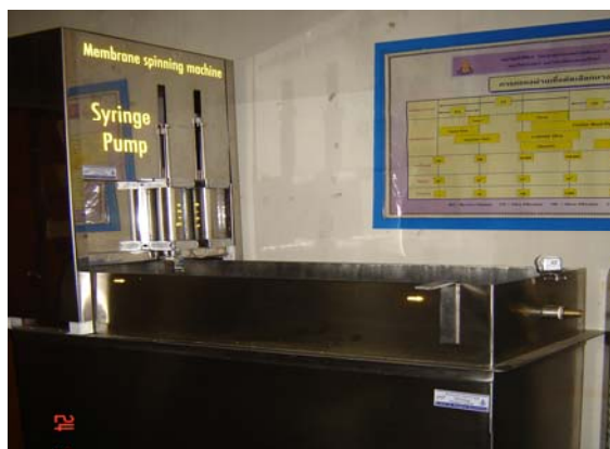
รูปที่ 3.4 เครื่องผลิตเมมเบรนท่อกกลาง (membrane spinning machine) (สถานวิจัยวิทยาศาสตร์และเทคโนโลยีเมมเบรน)
