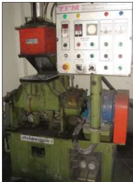
รูปที่ 3.2 แสดงเครื่องผสมยางแบบระบบปิด (Kneader)
