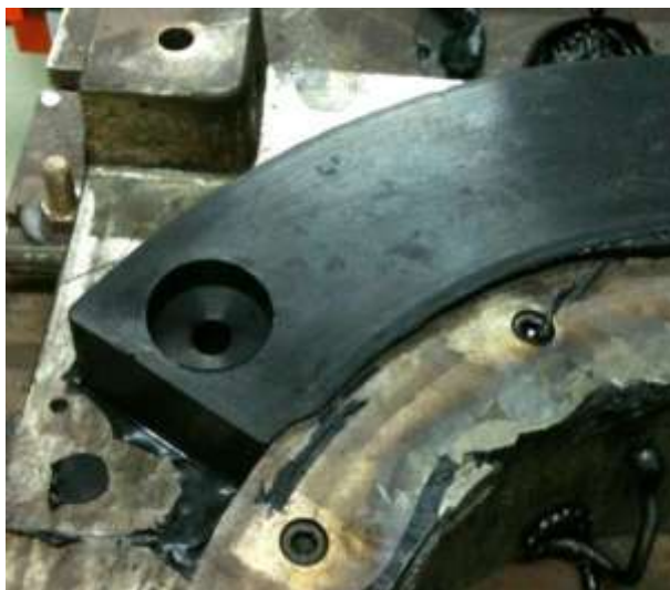
รูปที่ 4.17 แสดงชิ้นงานที่อัดขึ้นรูปหลังการตัดแปลงแม่พิมพ์
