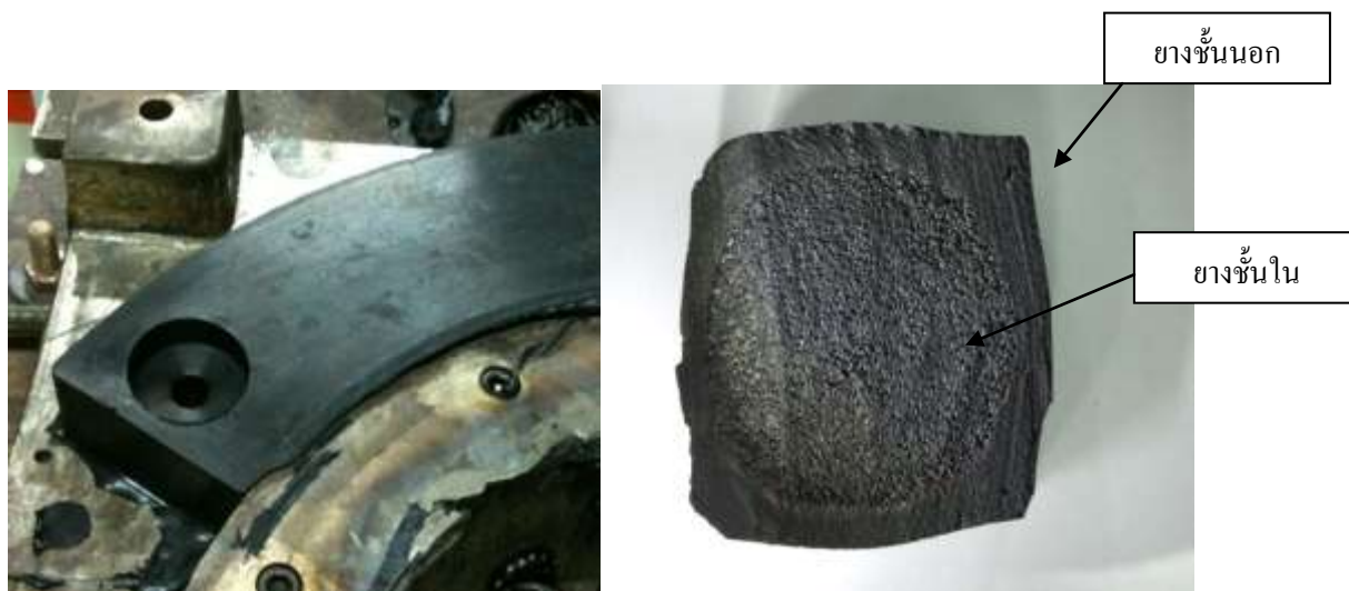
รูปที่ 3.17 (a) แสดงชิ้นงานหลังจากการอัดขึ้นรูป (b) แสดงภาพตัด Section ของชิ้นงานหลังจากการอัดขึ้นรูป
