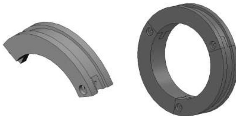
รูปที่ 4.9 แสดงรูปร่างของอุปกรณ์เสริมล้อยางลมแบบ RFSR 2
