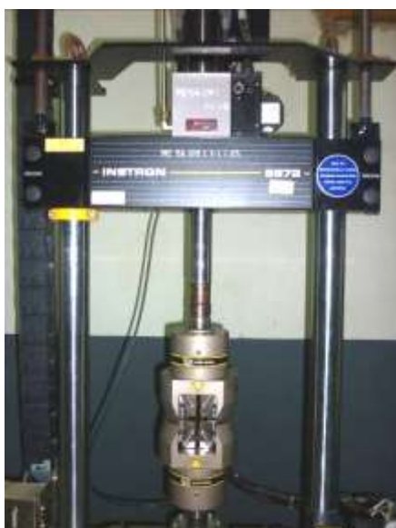
รูปที่ 3.9 แสดงเครื่องทดสอบการกดและทดสอบฮีสเทอรีซิสชิ้นงานตัวอย่าง
