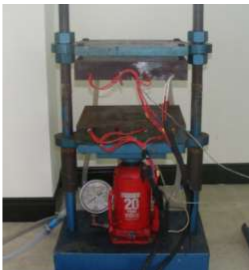
รูปที่ 3.4 แสดงเครื่องอัดขึ้นรูปยางแบบมีน้ำหล่อเย็นไหลผ่าน
