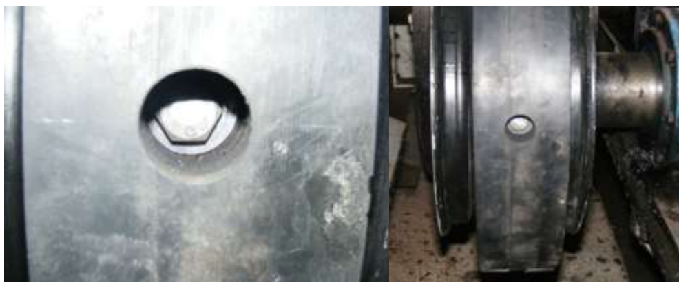
รูปที่ 4.21 แสดงการเจาะรูชิ้นงานและยึดด้วยสกรู
