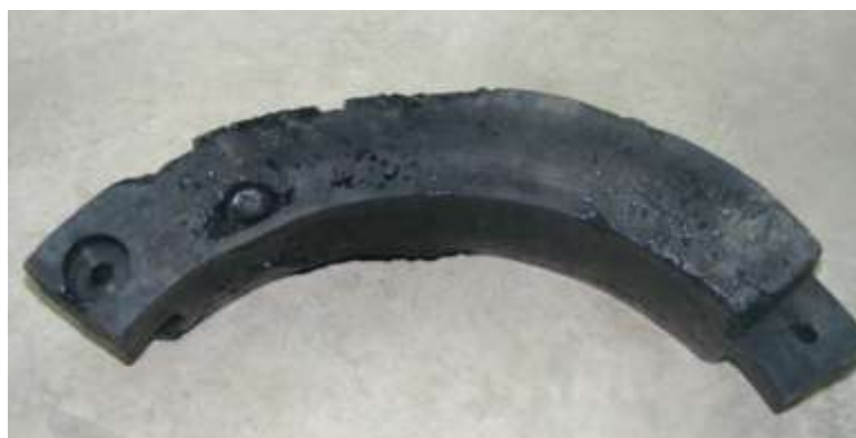
รูปที่ 4.13 แสดงลักษณะสูตรยางที่ไม่เต็มสารฟูและเคลย์ หลังการอัดขึ้นรูป
