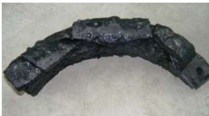
รูปที่ 4.12 แสดงลักษณะสูตรยางที่ผสมเคลย์หลังการอัดขึ้นรูป
