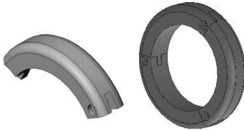
รูปที่ 4.10 แสดงรูปร่างของอุปกรณ์เสริมล้อยางแบบ RFSR3
