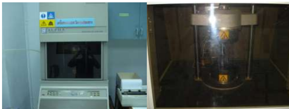
รูปที่ 3.11 เครื่องทดสอบเวลาวัลคาไนซ์ของยาง (Moving Die Rheometer MDR 2000)
