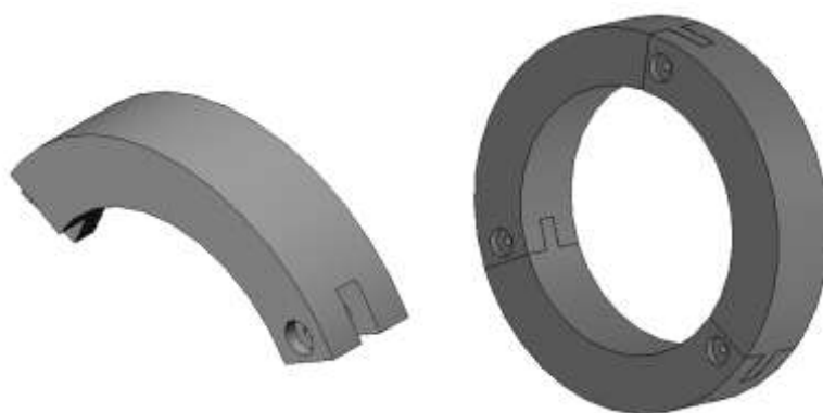
รูปที่ 4.8 แสดงรูปร่างของอุปกรณ์เสริมล้อยางลมแบบ RFSR1
