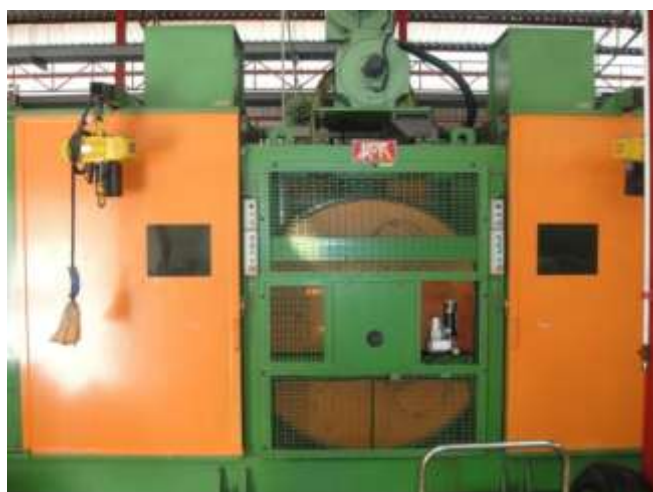
รูปที่ 3.15 เครื่องวัดความคงทนของยาง (Endurance) วัดโดยใช้ Drum Test
