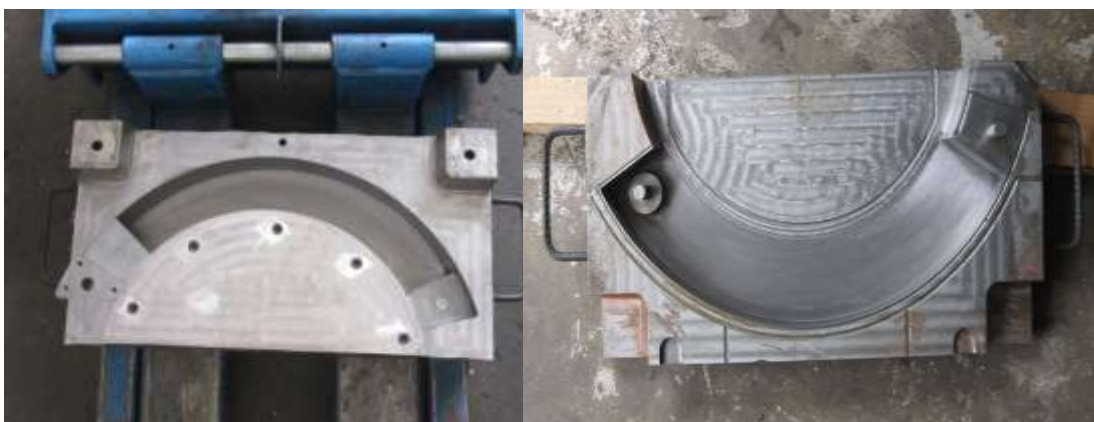
รูปที่ 4.11 แสดงแม่พิมพ์ที่ทำการออกแบบจากชิ้นงานแบบ RFSR1
