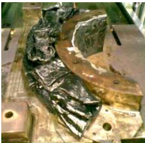
รูปที่ 3.16 แสดงการนำยางคอมปาวด์ชั้นในและชั้นนอกใส่ในแม่พิมพ์
