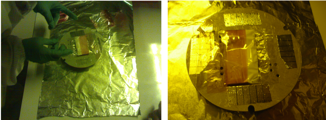
รูปที่ 3.6 การติดตั้งสารตัวอย่าง ก่อนทำการทดลอง สำหรับกระบวนการวัลคาไนเซชันด้วยการฉายแสงซินโครตรอน
