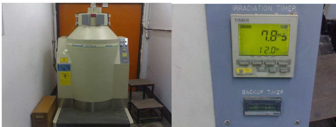
รูปที่ 3.4 เครื่องฉายรังสีแกมมา รุ่นGammacell 220 Excel ที่ศูนย์ฉายรังสีแกมมา สถาบันเทคโนโลยีนิวเคลียร์แห่งชาติ (สทท.)
