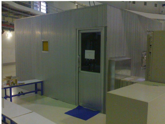
รูปที่ 3.9 ลักษณะห้องฉายแสงซินโครตรอน ภายใต้สภาวะการทดลองของโครงสร้างระบบลำแสง BL-6 (X-ray Lithography, XRL)
