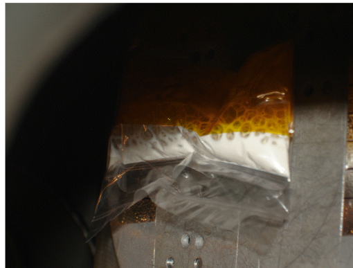
รูปที่ 3.7 การติดตั้งสารตัวอย่าง ภายในเครื่องฉายแสงซินโครตรอน สำหรับกระบวนการวัลคาไนเซชันด้วยการฉายแสงซินโครตรอน
