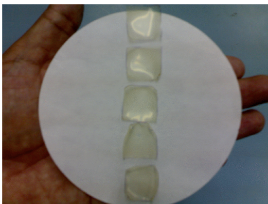
รูปที่ 3.12 แผ่นฟิล์มยางในลักษณะฟิล์มบาง ที่ตัดเป็นแผ่นสี่เหลี่ยมจัตุรัส ขนาด 2 \times 2 \text{ cm}^2 ก่อนนำมาแช่ในสารละลายโทลูอีน
