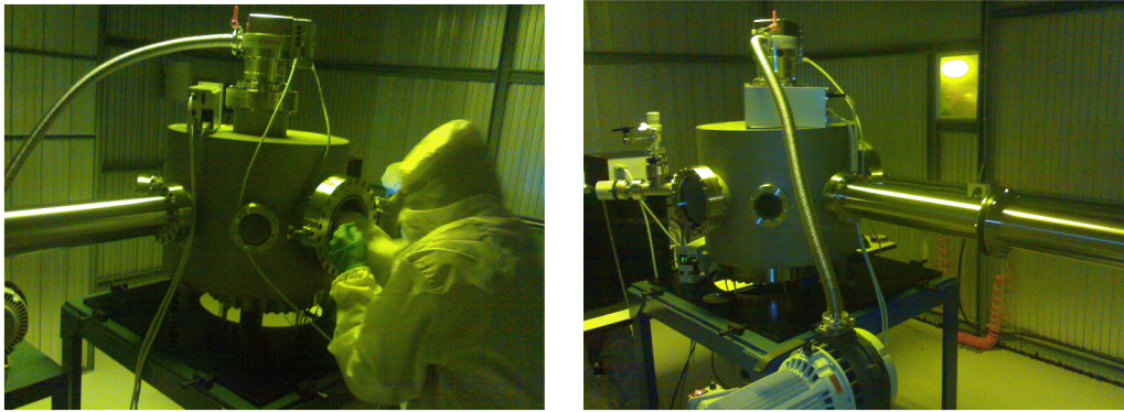
รูปที่ 3.8 ลักษณะเครื่องฉายแสงซินโครตรอน ภายใต้สภาวะการทดลองของโครงสร้างระบบลำแสง BL-6 (X-ray Lithography, XRL) ในส่วนของ การอบรังสีวัสดุ (material X-Ray exposure)
