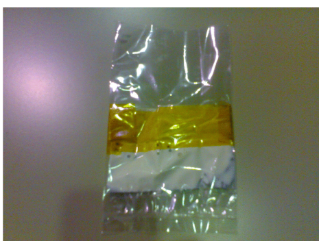
รูปที่ 3.5 ถุงพลาสติกขนาดเล็ก (หนาประมาณ 70 ไมโครเมตร) เพื่อใส่น้ำยาง สำหรับกระบวนการวัลคาไนเซชันด้วยการฉายแสงซินโครตรอน
