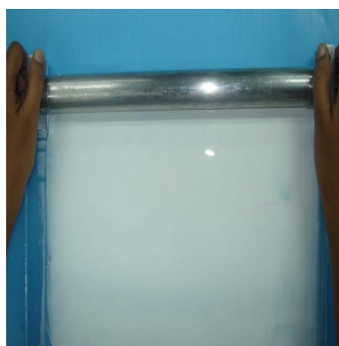
รูปที่ 3.10 การปาดน้ำยางด้วย casting knife
