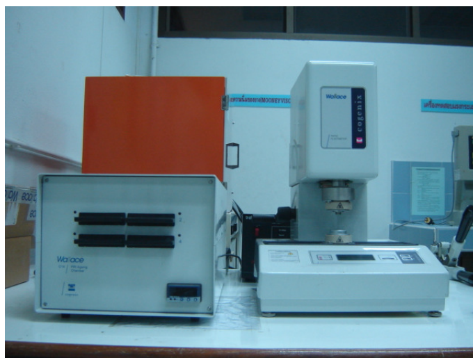
รูปที่ 3.3 เครื่องวัดความนิ่มของยาง (Wallace Rapid Plastometer)
