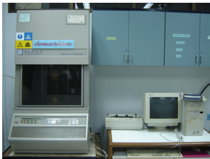
รูปที่ 3.6 เครื่องวัดลักษณะการวัลคาไนซ์ของยาง (Moving Die Rheometer, MDR 2000)
