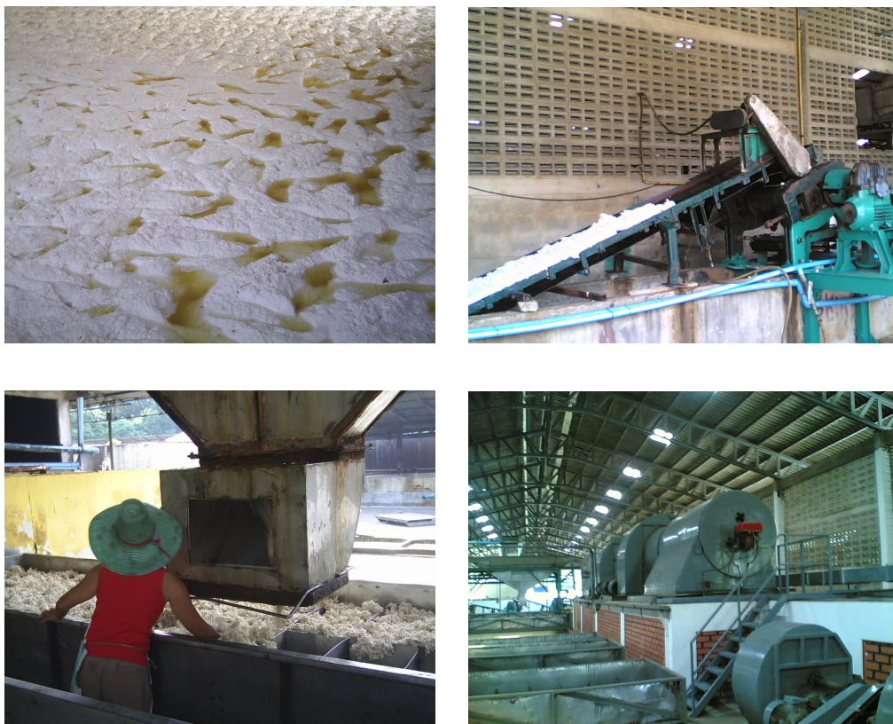
รูปที่ 2.8 แสดงขั้นตอนการเตรียมยางแท่งสกิม
