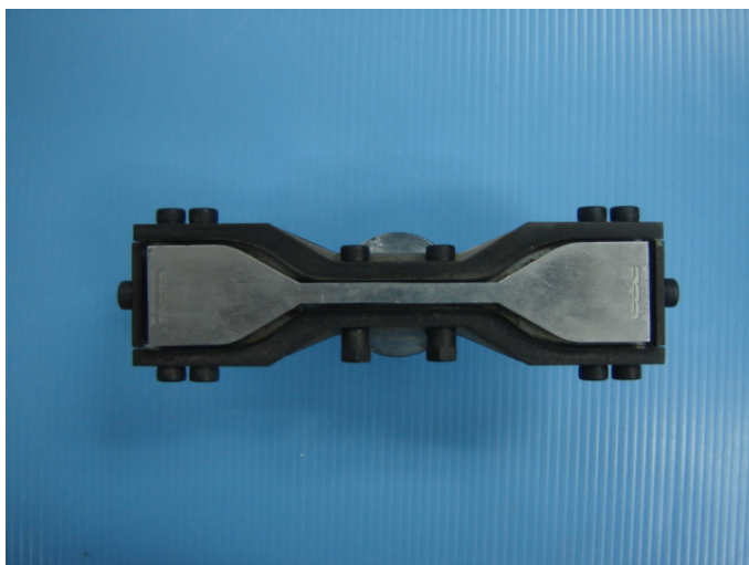
รูปที่ 3.15 เครื่องตัดชิ้นตัวอย่างรูปดัมเบล
