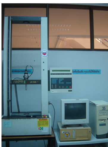
รูปที่ 3.7 เครื่องทดสอบหาความทนต่อแรงดึง (Tensometer)
