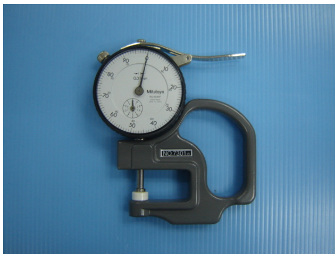
รูปที่ 3.16 เครื่องวัดความหนา (Thickness meter)
