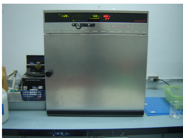
รูปที่ 3.9 ตู้อบอากาศร้อน (Hot Air Oven)
