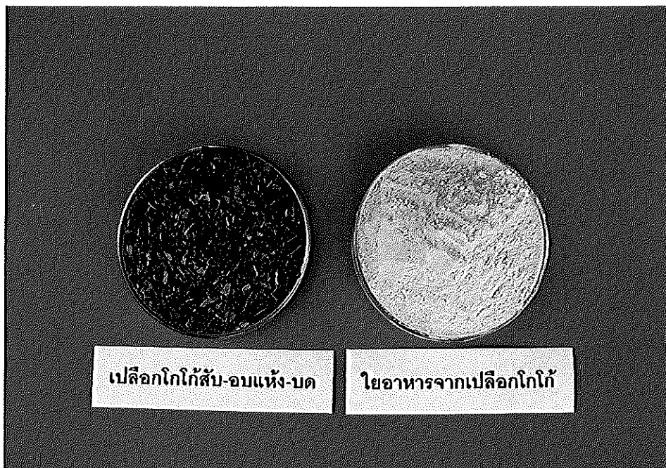
ภาพที่ 10 เปลือกโกโก้ที่ใช้เป็นวัตถุดิบในการสกัด และใยอาหารที่สกัดได้จากเปลือกโกโก้ หลังจากบดและคัดขนาดต่ำกว่า 60 เมช
