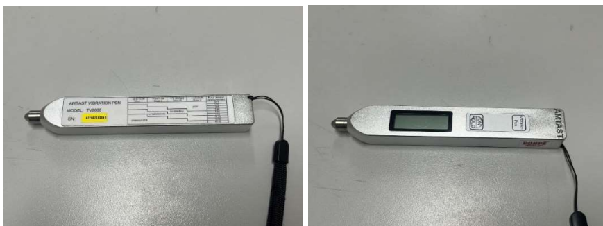
ภาพที่ 35 เครื่อง HAND HELD VIBRATION METER ยี่ห้อ AMTAST รุ่น TV2000
