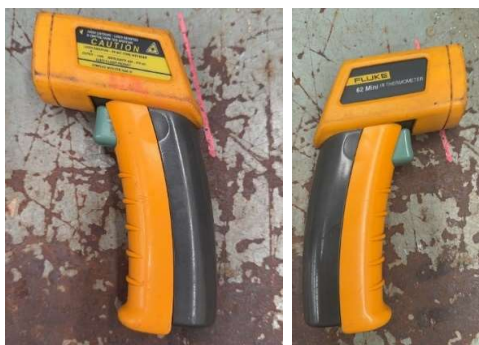
ภาพที่ 36 เครื่อง Mini Infrared Thermometer ยี่ห้อ Fluke 62
