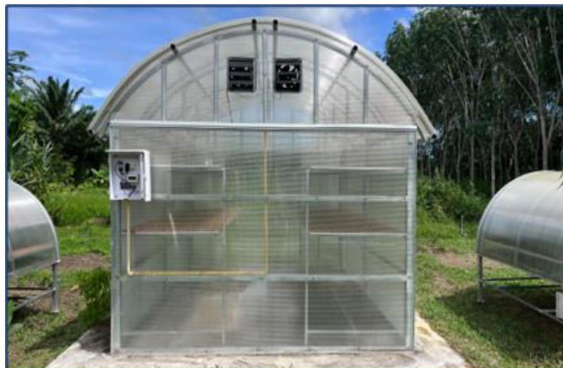
ภาพที่ 1.3 โรงอบแห้งพลังงานแสงอาทิตย์ ของกลุ่มวิสาหกิจชุมชนกาแพรัชฎาฯ
