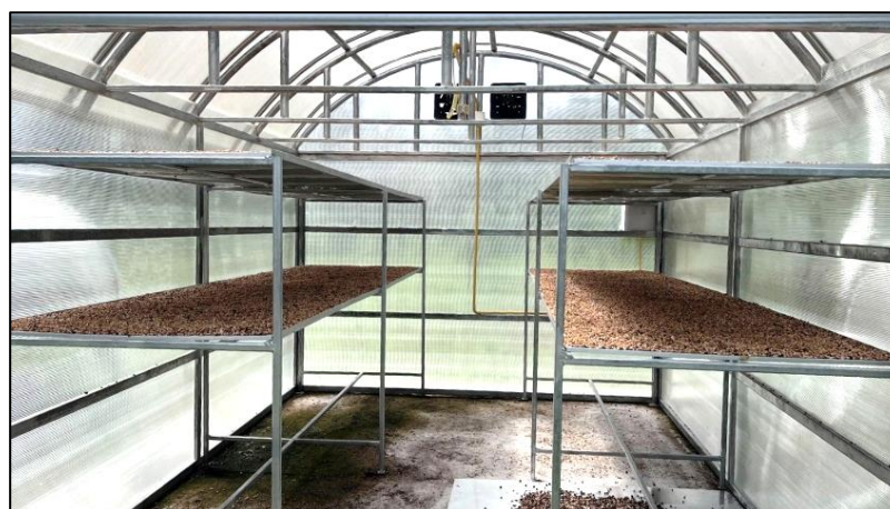
ภาพที่ 1.4 การตากแห้งเมล็ดกาแฟด้วยโรงอบแห้งพลังงานแสงอาทิตย์ ของกลุ่มวิสาหกิจชุมชนกาแพรัชฎาฯ
