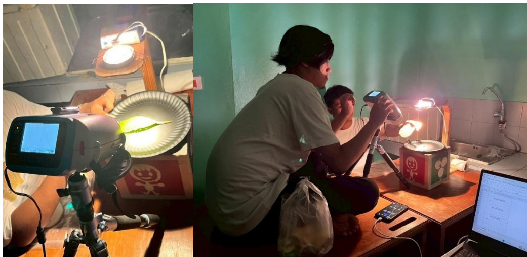
รูปที่ 3.5 การตรวจวัดค่าการสะท้อนแสงของใบไม้ ด้วยเครื่อง Spectroradiometer
