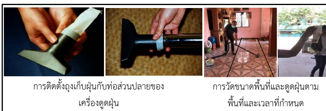
รูปที่ 3.2 ขั้นตอนการเก็บตัวอย่างฝุ่นภายในอาคาร
