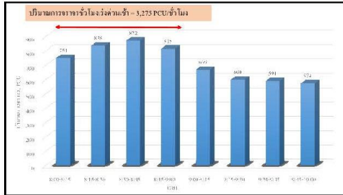
รูปที่ 4 ปริมาณการจราจรชั่วโมงเร่งด่วนเช้า
