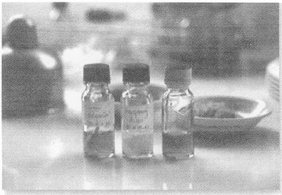
ภาพประกอบภาคผนวก 5 การอ่านรายงานผลชุดทดสอบ SI-2 ผลบวกสารละลายเปลี่ยนจากสีม่วง เป็นสีเหลือง
