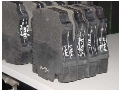
รูปที่ 4.29 ชั้นยางที่ผ่านการตัดเพื่อตรวจสอบความสมมาตรของหน้าตัด
