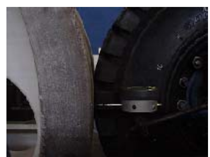
รูปที่ 3.13 การติดตั้งเกจวัดระยะเพื่อวัดระยะยุบของล้อยาง
