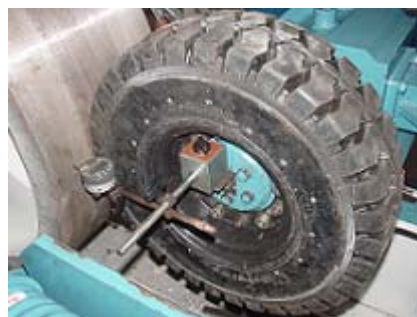
รูปที่ 3.13 การติดตั้งเกจวัดระยะเพื่อวัดระยะยุบของล้อยาง
