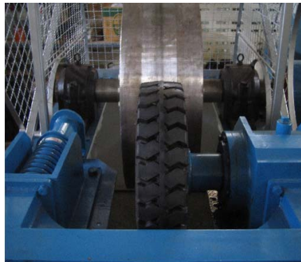
รูปที่ 3.5 การติดตั้งล้อยางบนเครื่องทดสอบ
