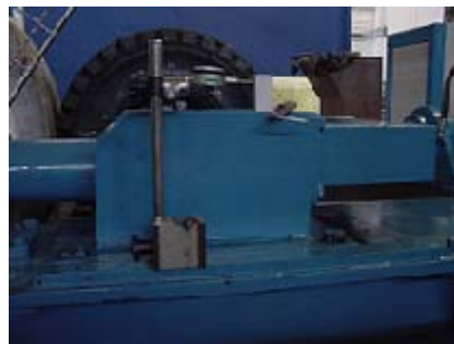
รูปที่ 3.12 การติดตั้งเกจวัดระยะเพื่อวัดระยะยุบของสปริง
