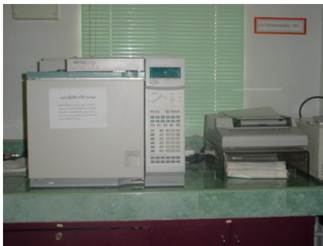
ภาพประกอบ ก.1 เครื่องก๊าซโครมาโทกราฟฟี (GC/FID) ของบริษัท Hewlett Packard รุ่น 6890
