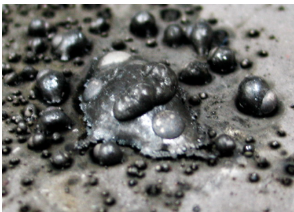
รูปที่ 4.5 ลักษณะทางกายภาพชิ้นงานของสารผลิตภัณฑ์ที่สังเคราะห์ด้วยปฏิกิริยา SHS จากระบบสารตั้งต้น WO_3+Si+Al
