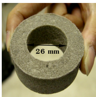
รูปที่ 3.11 ลักษณะของเบ้าทรายหลังการเผาที่อุณหภูมิ 400°C เป็นเวลา 3 ชั่วโมง
