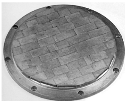
รูปที่ 2.20 รูปแบบการเรียงแท่งสารประกอบเชิงโลหะ WSi_2 ในลักษณะโมเสก (Glebovsky et al., 1998)
