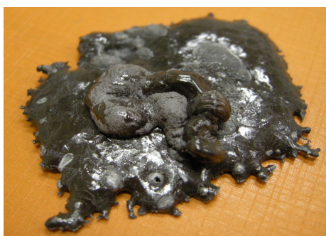
รูปที่ 4.8 ลักษณะทางกายภาพชิ้นงานของสารผลิตภัณฑ์ที่สังเคราะห์ด้วยปฏิกิริยา SHS จากระบบสารตั้งต้น \text{WO}_3+\text{B}_2\text{O}_3+\text{Al}
