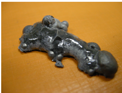
รูปที่ 4.11 ลักษณะทางกายภาพชิ้นงานของสารผลิตภัณฑ์ที่สังเคราะห์ด้วยปฏิกิริยา SHS จากระบบสารตั้งต้น WO_3+SiO_2+Al
