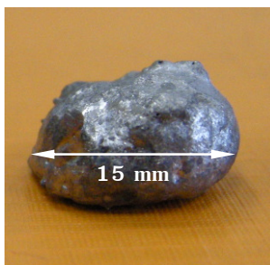
รูปที่ 4.72 ลักษณะของแท่งสารประกอบเชิงโลหะที่สังเคราะห์ด้วยปฏิกิริยา SHS จากระบบสารตั้งต้น \text{WO}_3+\text{B}_2\text{O}_3+\text{Al} ที่มีการเติม \text{CaO}_2-\text{Al}
