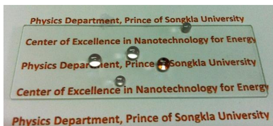
รูปที่ 4.14 แสดงพื้นผิวที่มีสมบัติไม่ชอบน้ำยิ่งยวดและมีความใส
