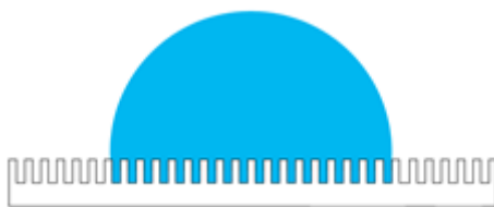
รูปที่ 2.4 แสดงหยดน้ำบนพื้นผิวที่มีความขรุขระของแบบจำลอง Wenzel
