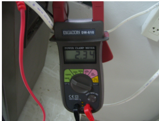
ภาพประกอบที่ ซ.8 แสดงการวัดพลังงานไฟฟ้าที่สูญเสียในระบบเครื่องปรับอากาศ
