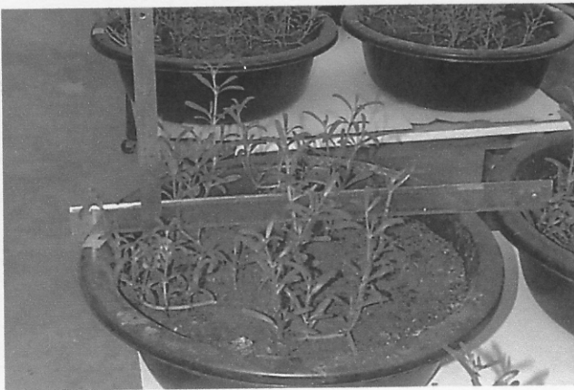
ภาพประกอบ 31 การวัดความสูง โดยการวัดความยาวของกิ่งหลักของผักเบี้ยทะเล
