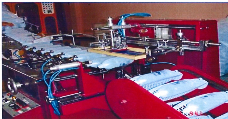
ภาพที่ 3.3 เครื่องพิมพ์สกรีนอัตโนมัติ
