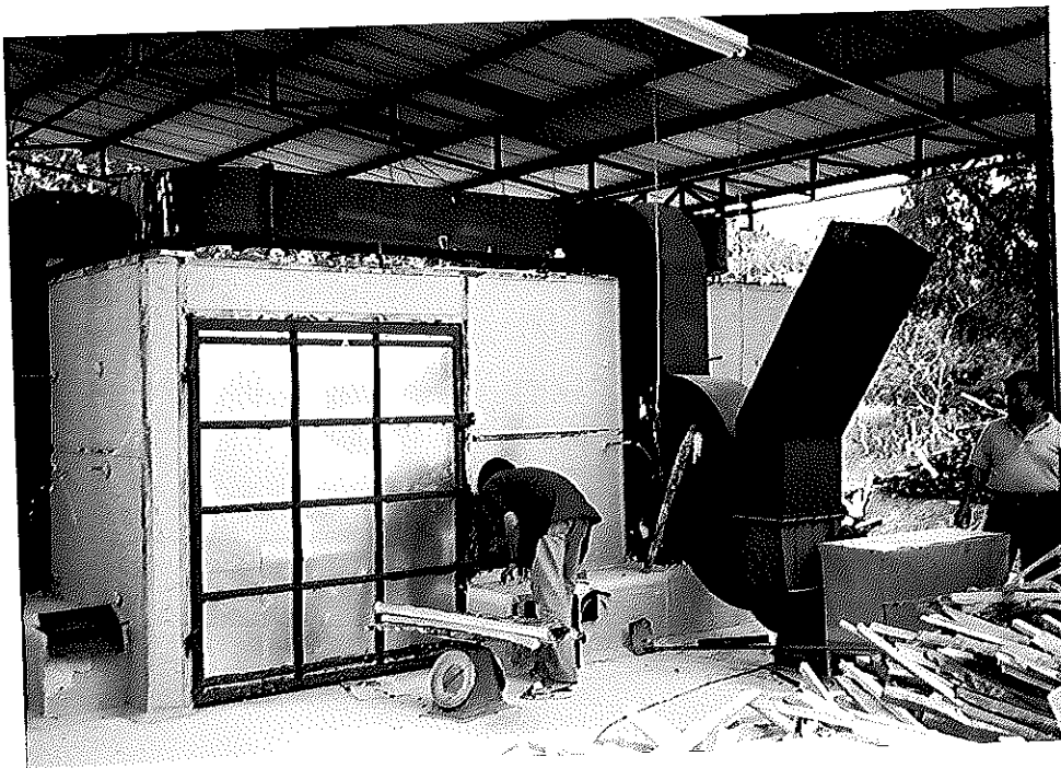
รูปที่ ผ.4.27 การใส่ฟืนในเตาเผาอิฐขณะทดลอง
