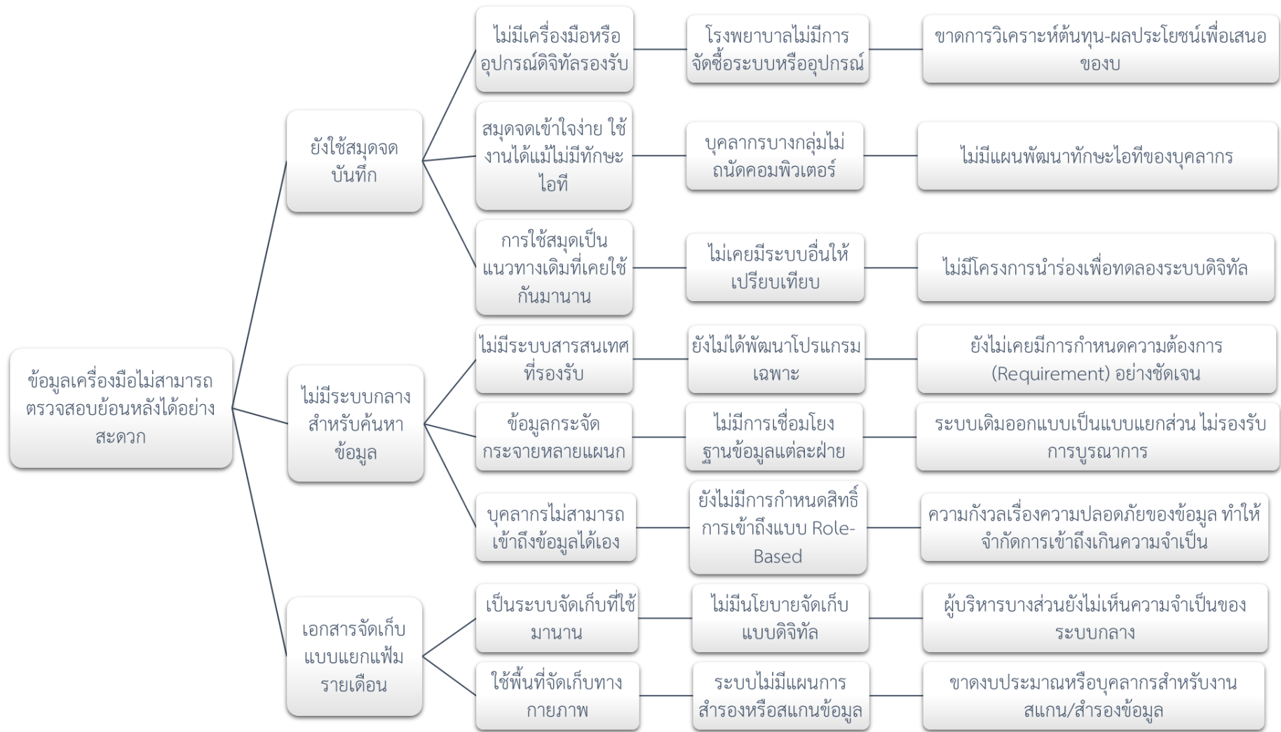
ภาพที่ 13 การวิเคราะห์สาเหตุรากเหง้าของปัญหาข้อมูลเครื่องมือแพทย์ไม่สามารถตรวจสอบย้อนหลังได้อย่างสะดวก ด้วย Why-Why Analysis
