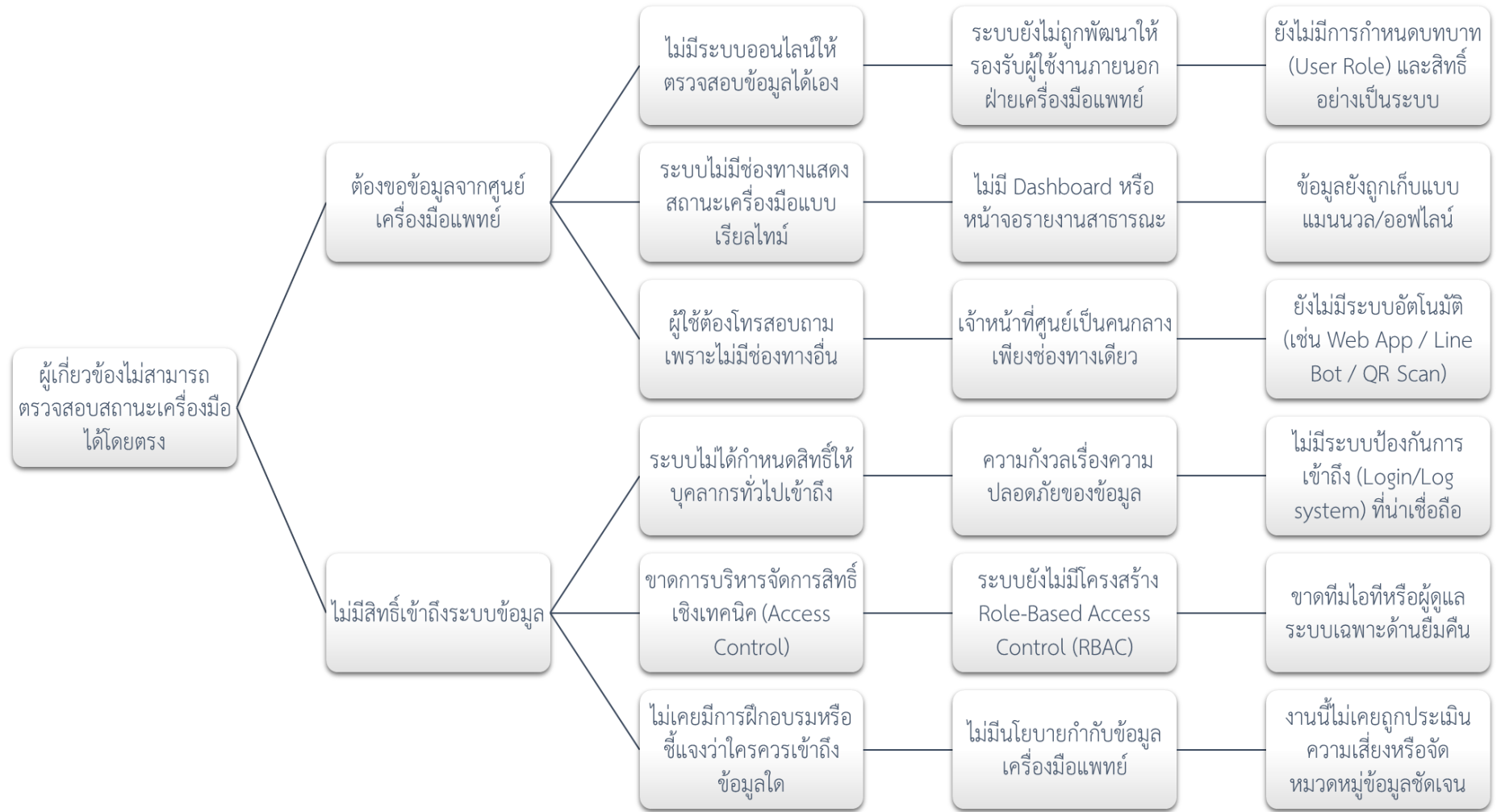
ภาพที่ 14 การวิเคราะห์สาเหตุรากเหง้าของปัญหาผู้เกี่ยวข้องไม่สามารถตรวจสอบสถานะเครื่องมือได้โดยตรง ด้วย Why-Why Analysis
