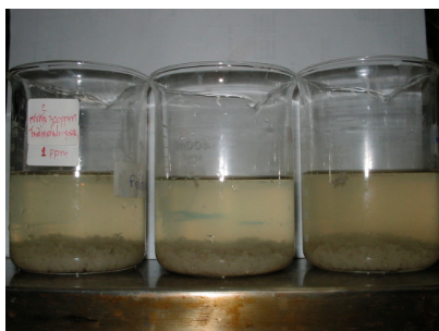
3.5-1 รวมตะกอนด้วยพอลิเมอร์แบบประจุลบ ที่ปริมาณ 1 มิลลิกรัมต่อลิตร
