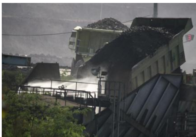
รูปที่ 4.7 ระบบสเปรย์น้ำที่โรงโม่
