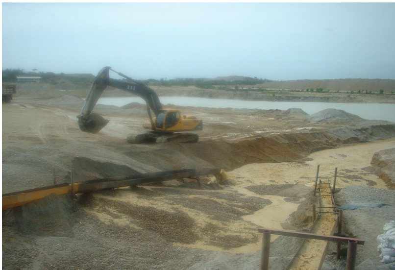
รูปที่ 4.29 ภาพกรวดทรายที่เหลือจากการแต่งแร่พลอย
