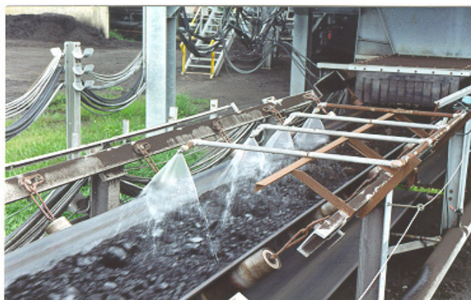
รูปที่ 4.6 ระบบสเปรย์น้ำที่สายพานลำเลียง
