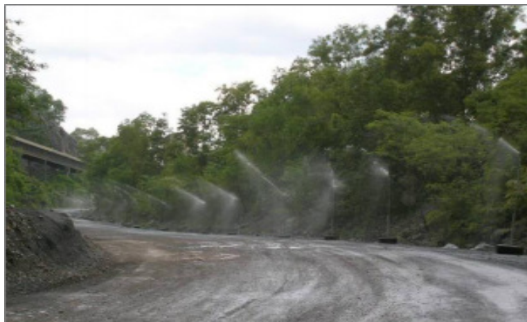
รูปที่ 4.47 การใช้สเปรย์น้ำเพื่อดับฝุ่นในเส้นทางการขนส่ง
