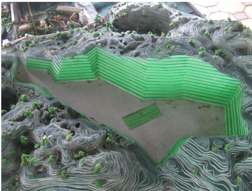
รูปที่ 4.49 เทคนิคการทำเหมืองแบบ Semi-opencut mining
