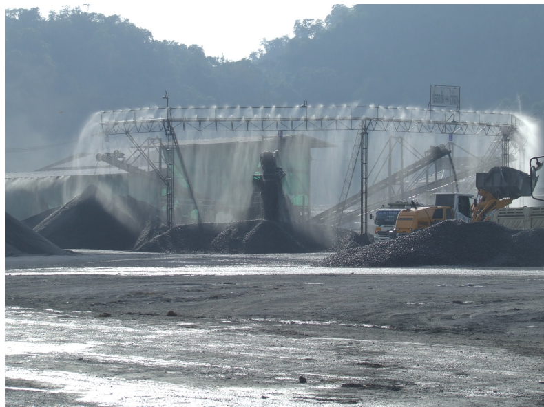
รูปที่ 5.12 ภาพถ่ายการใช้ม่านน้ำเพื่อดักจับฝุ่นจากโรงโม่หิน ถ่ายเมื่อวันที่ 11 มิถุนายน 2551
