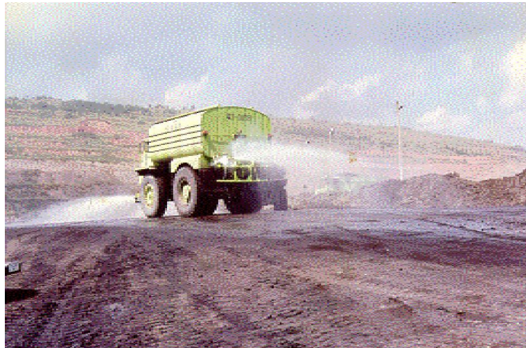
รูปที่ 4.8 ภาพรถบรรทุกฉีดพรมน้ำบนถนนเพื่อลดฝุ่นละออง
