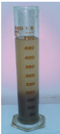
ภาพประกอบ 2.5 การทดสอบการตกตะกอน V_{30}
