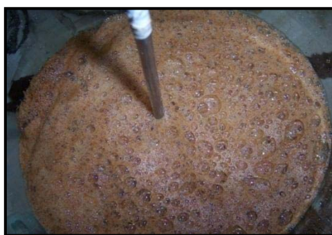
ภาพประกอบที่ 4-2 ฟองก๊าซ H_2CO_3 ที่เกิดขึ้นจากการทำปฏิกิริยาการกำจัดแคลเซียมคาร์บอเนตในกระบวนการผลิตไคติน
