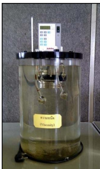
ภาพประกอบที่ 3-9 แสดงภาพเครื่องมือวัดค่าความหนืดสัมพัทธ์ชนิด
