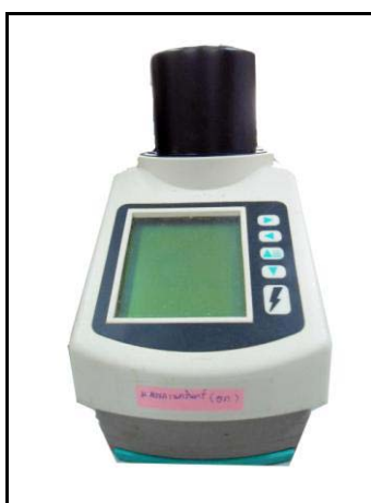
ภาพประกอบที่ 3-13 แสดงเครื่องวัดสีอาหาร Hunter Lab รุ่น Color Flex
