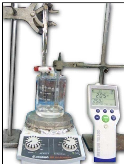
ภาพประกอบที่ 3-7 ชุดการวิเคราะห์หา Degree of Deacetylation (%DD)
