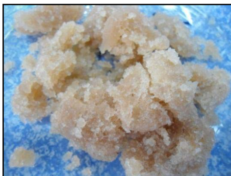
ภาพประกอบที่ 4-3 แสดงลักษณะของไคตินที่ได้หลังจากทำการกำจัดแคลเซียมคาร์บอเนต
