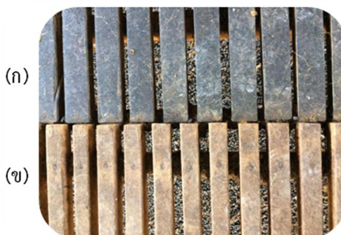
รูปที่ 4.19 ระแนงเทียมจากพอลิเมอร์เบลนด์ที่นำไปทดลองติดตั้งใช้งานเป็นพื้นปูคอกแพะจริงเพื่อเปรียบเทียบการใช้งานกับไม้จริง
