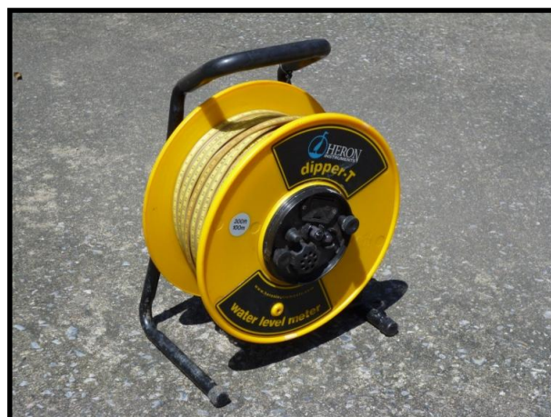
รูปที่ 2.2 เทปวัดระดับน้ำบาดาล GPS เครื่องพิกัดตำแหน่งที่ตั้ง
