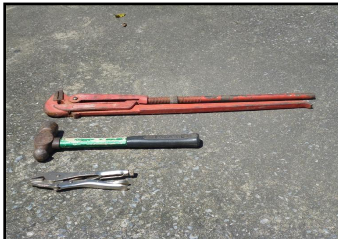
รูปที่ 2.4 อุปกรณ์เปิดปากบ่อ ได้แก่ ปะแจคคอมม่า คีมล๊อค ค้อนปอนด์
