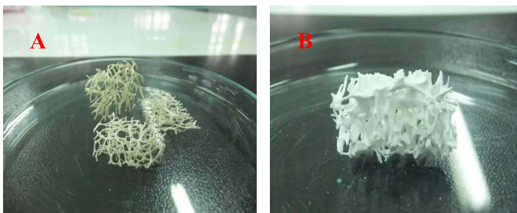
รูปที่ 3.3 ใยบวบที่เตรียมสำหรับขึ้นรูปโครงเลี้ยงเซลล์กระดูก (A) และโครงเลี้ยงเซลล์กระดูกหลังจากการเผาซินเตอร์ (B)
