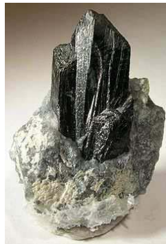
รูปที่ 1.8 แร่แบดเดเลย์ไอต์ (Baddeleyite) เป็นเซอร์โคเนียที่มีโครงสร้างแบบโมโนคลินิก [5]
