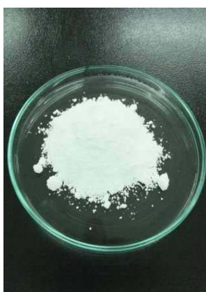
รูปที่ 1.7 เซอร์โคเนียมออกไซด์หรือเซอร์โคเนีย
