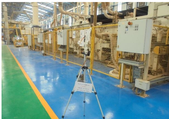
ภาพที่ 2-5 การเก็บตัวอย่างอากาศประเภทติดตั้งกับพื้นที่
