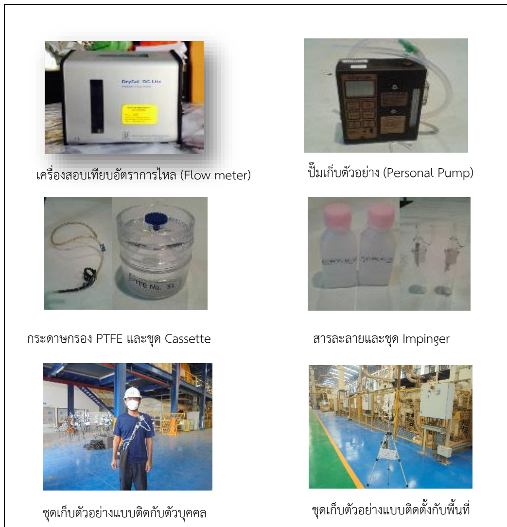
ภาพที่ 2-1 เครื่องมือและชุดอุปกรณ์สำหรับเก็บตัวอย่างสารฟอร์มัลดีไฮด์แบบติดกับตัวบุคคลและติดตั้งกับพื้นที่
