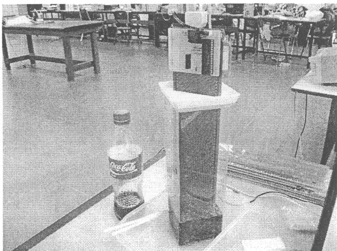
รูปที่ 8-27 การวัดระดับน้ำอัดลมด้วยเซนเซอร์
