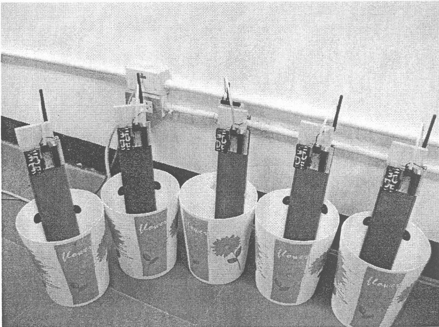
รูปที่ 8-51 การจำลองการวัดระดับน้ำ โดยส่งข้อมูลผ่านเครือข่ายเซนเซอร์ไร้สาย
