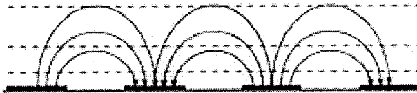
รูปที่ 6-15 รูปแบบของสนามไฟฟ้าของอิล็กโทรดแบบอินเตอร์ดิจิตอลที่มีลักษณะคล้ายวงรี[30]
