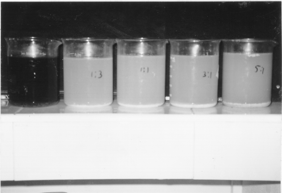
รูปที่ 4.35 การเปลี่ยนแปลงของระบบบำบัดแบบไร้อากาศ หลังการใช้ต่าง \text{NaOH} ปรับสภาพน้ำเสียที่มีส่วนผสม น้ำเสียจากกระบวนการสกิม: น้ำเสียจากกระบวนการผลิตน้ำยางชั้น 1:5, 1:3, 1:1, 3:1 และ 5:1 ตามลำดับ
