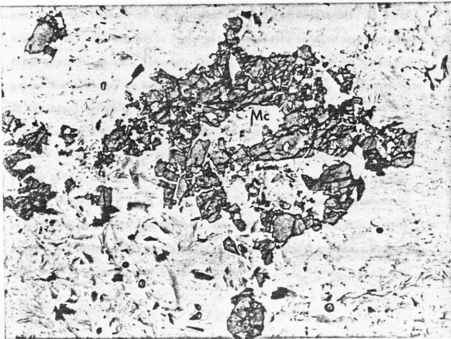
รูปที่ 3.6.2-1 แสดงการเกิดแร่ดีบุกและแร่โคไวต์ภายใต้การเปลี่ยนสภาพชนิด greisenization Cluster of fine-grained cassiterite (Cs) with inter- grown muscovite (Mc)
