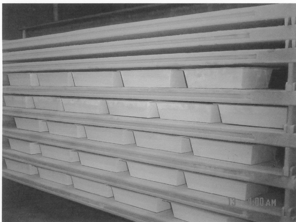
ภาพที่ 6 แสดงการแช่เยือกแข็งผลิตภัณฑ์อาหารฮาลาลพร้อมบริโภคด้วยเครื่อง Contact Plate Freezer
