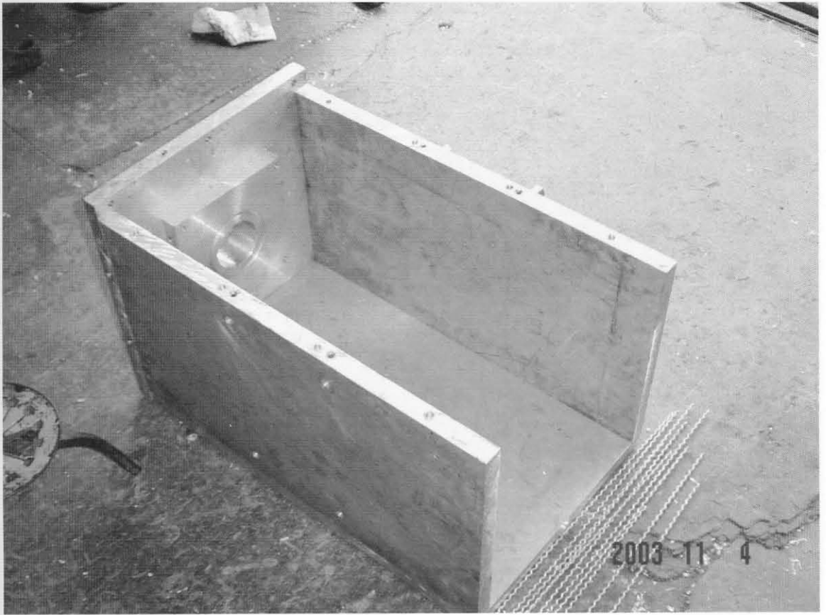
รูปที่ 11 แสดงขณะทดลองประกอบชิ้นส่วนอะลูมิเนียมผสมที่เตรียมไว้เป็น sample chamber การทดลองประกอบทำเพื่อตรวจสอบความถูกต้องในการสร้างชิ้นงาน ถ้ามีข้อผิดพลาดจะได้ทำการแก้ไขให้ถูกต้องเสียก่อน
