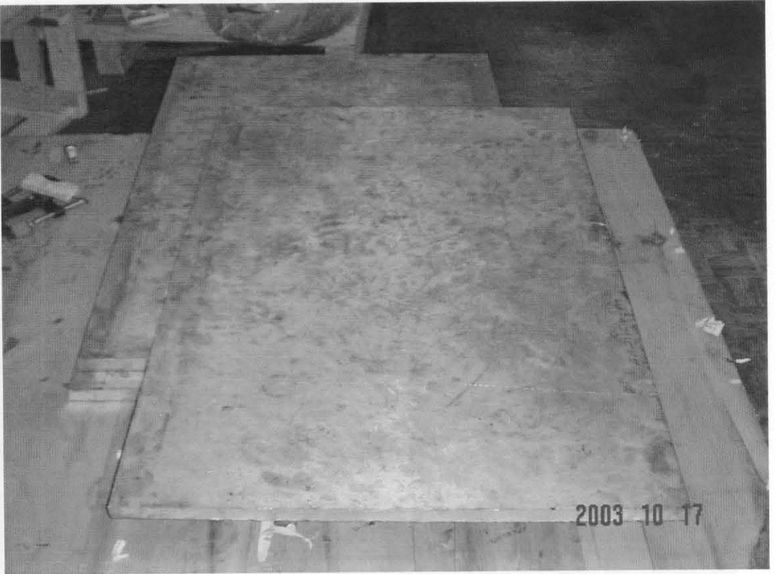
รูปที่ 5 แสดงแผ่นอะลูมิเนียมผสมที่แบ่งย่อยจากแผ่นตามรูปที่ 4 เป็น 3 ส่วน (น้ำหนักส่วนละ 90 กก.) เพื่อความสะดวกในการขนย้ายมายังห้องทดลอง
