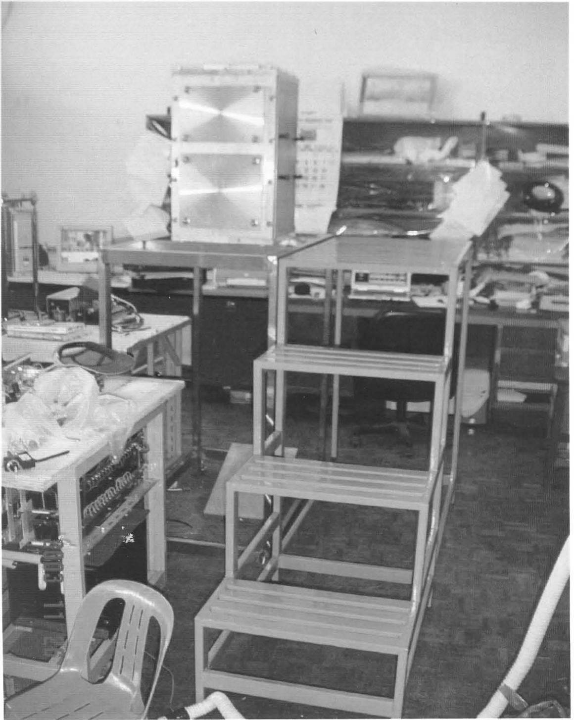
รูปที่ 15 แสดงโครงสร้างเหล็กขนาด 22 x 70 x 48 นิ้วเพื่อใช้เป็นบันไดสำหรับขึ้นลงในการติดตั้งอุปกรณ์บริเวณด้านบนของ Sample chamber สำหรับที่วางใต้บันไดเตรียมไว้ติดตั้งอุปกรณ์อิเล็กทรอนิกส์บางส่วนสำหรับควบคุมการทำงานของเครื่องมือ
