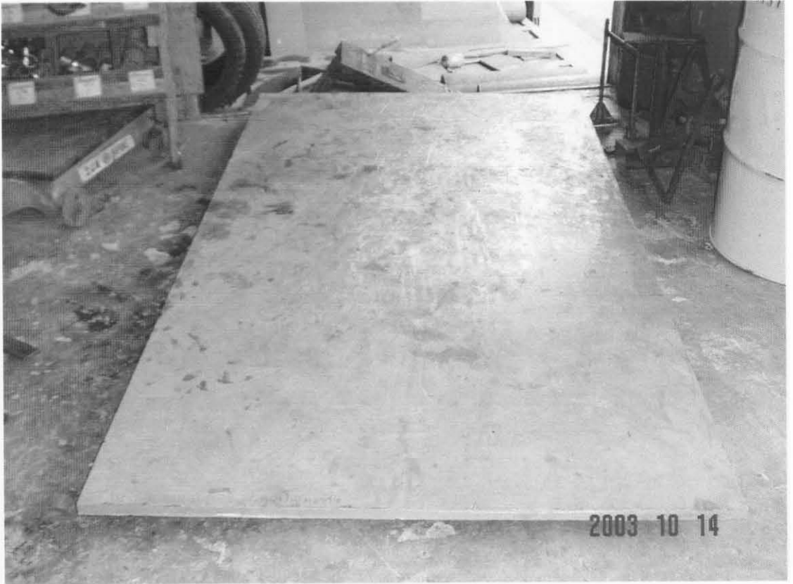
รูปที่ 4 แสดงแผ่นอะลูมิเนียมผสม ขนาดกว้าง 4 ฟุต ยาว 8 ฟุต หนา 1 นิ้ว หนัก 270 กก. ราคาประมาณ 39,000 บาท เพื่อนำมาใช้สร้าง Sample Chamber และอุปกรณ์บางส่วนของ Sample Loading, Pulling and Spinning Unit
