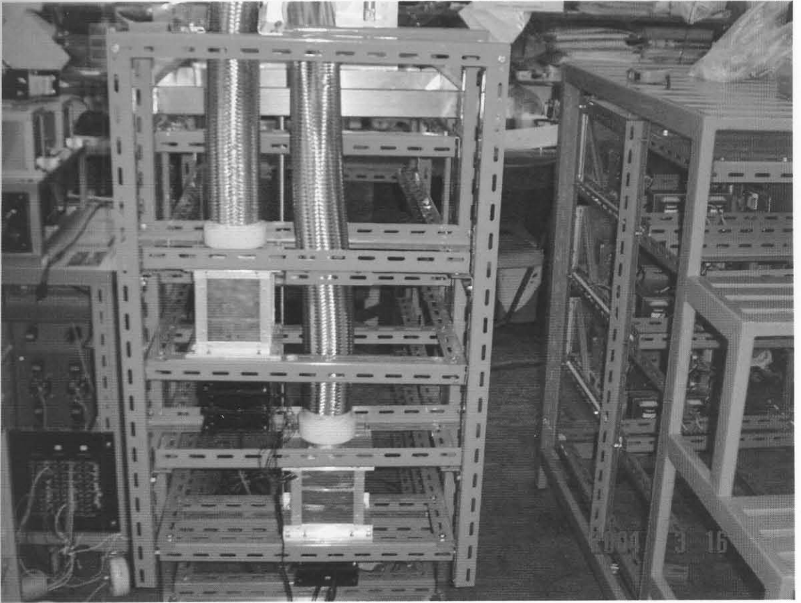
รูปที่ 26 แสดงภาพ Blower Fan จำนวน 2 ตัวที่ทดลองสร้างเพื่อทดสอบการทำงานของ Air Cooling System สำหรับ Quartz tube ใน Sample Chamber โดยใช้ Rotary Fan จำนวน 7 ตัว ผลการทดลองพอใช้งานได้ แต่ความแรงลมไม่มากพอ จะต้องทำการปรับปรุงดัดแปลงใหม่
