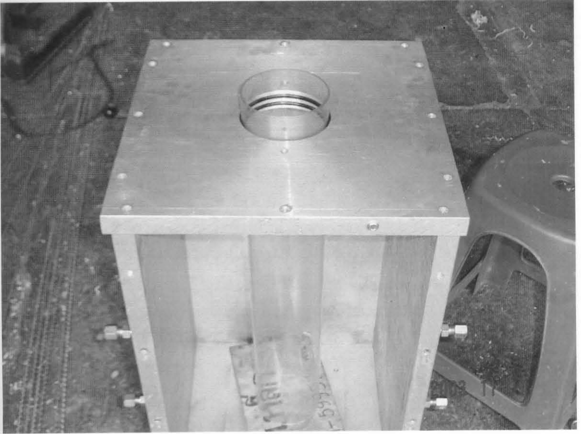
รูปที่ 12 แสดง sample chamber ขณะทดลองติดตั้งหลอดแก้ว quartz ขนาดใหญ่ (เส้นผ่าศูนย์กลาง 4 นิ้ว ยาว 24 นิ้ว) ทำหน้าที่เป็นแกนเตา
