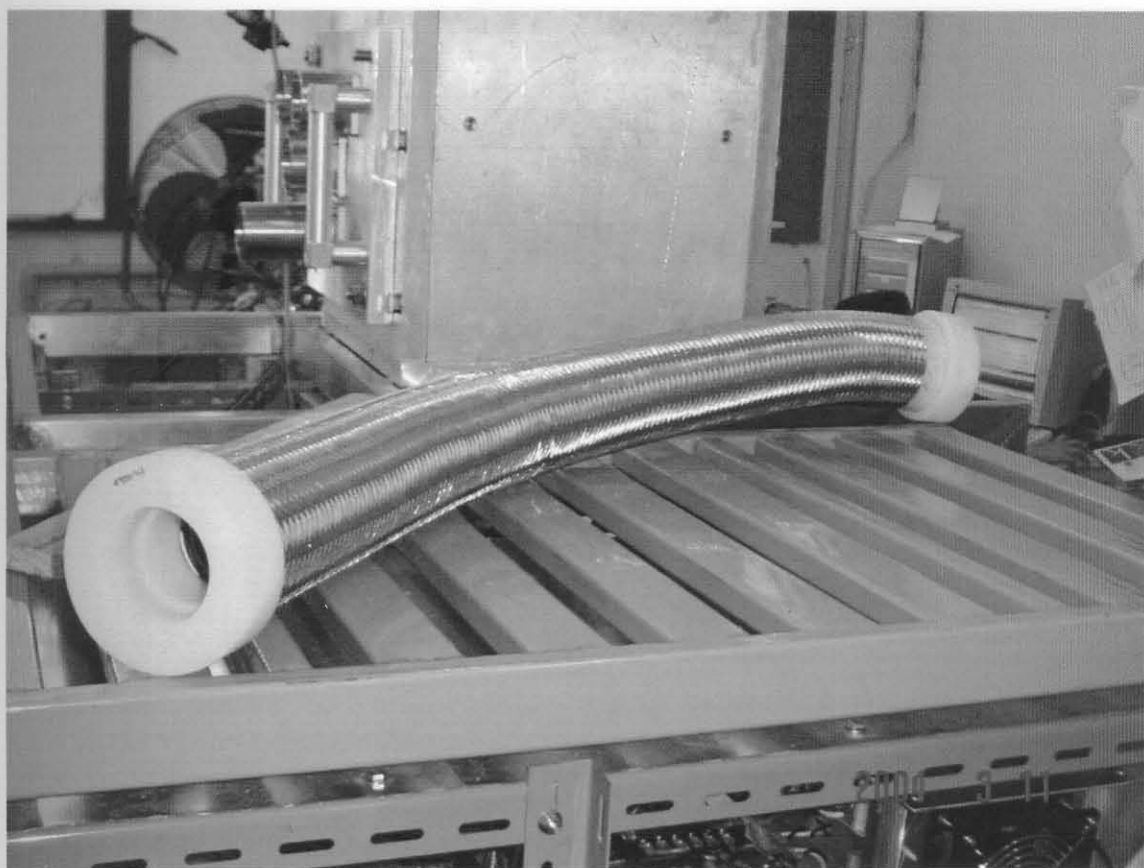
รูปที่ 24 เป็น Flexible tube ทำด้วย stainless steel ขนาดเส้นผ่าศูนย์กลาง 3.5 นิ้ว ยาว ประมาณ 1 เมตรปลายทั้งสองข้างใช้ Teflon ทำเป็นหน้าแปลนเพื่อใช้ต่อกับ Blower Fan และ Sample Chamber เพื่อประกอบเป็น Air Cooling System สำหรับ Quartz tube
