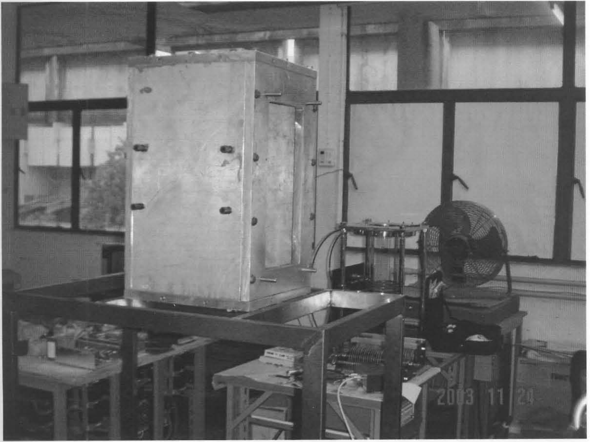
รูปที่ 14 แสดง sample chamber ติดตั้งบนฐานรับที่สร้างจาก stainless steel ขนาด 24 x 40 x 48 นิ้ว ตามรูปมองเห็นช่องเปิดขนาด 8 x 17 นิ้วที่ฝ้าด้านหน้าเตรียมไว้สำหรับเป็นช่องเปิดเพื่อติดตั้งอุปกรณ์ภายใน chamber
