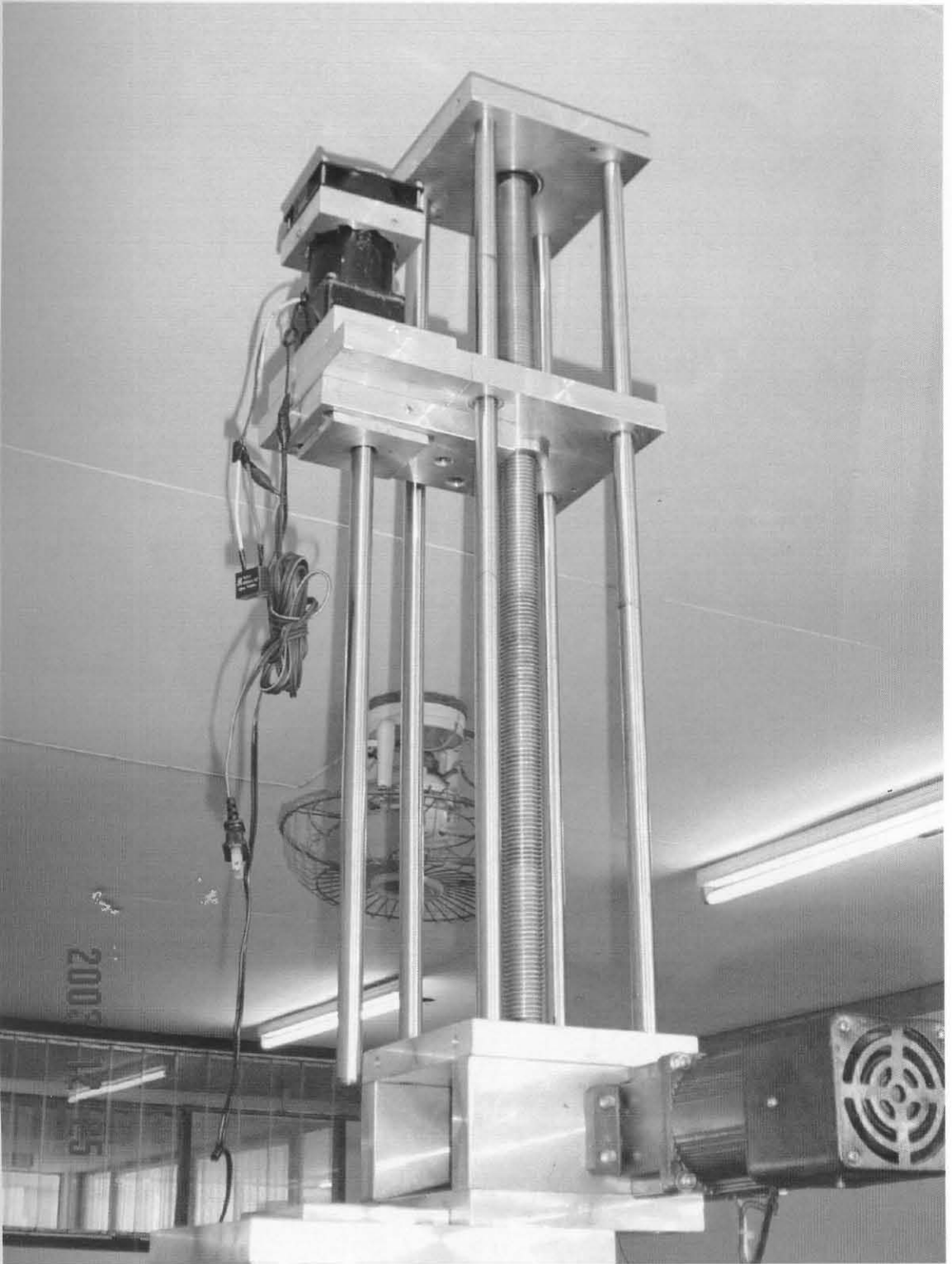
รูปที่ 17 แสดง sample spinning & pulling unit ติดตั้งบน sample chamber มอเตอร์ด้านบนทำหน้าที่หมุนแกนดึงผลึก มอเตอร์ด้านล่างทำหน้าที่หมุนแกนดึงผลึก
