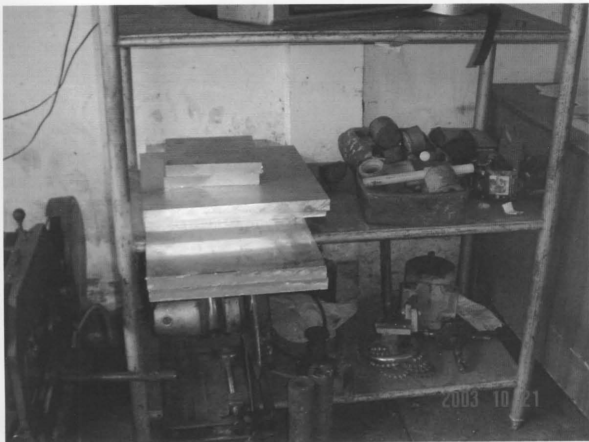
รูปที่ 7 แสดงชิ้นส่วนอะลูมิเนียมผสมส่วนหนึ่งที่ถูกตัดเป็นชิ้นเล็ก เพื่อเตรียมไว้สำหรับสร้าง Sample chamber ชิ้นอะลูมิเนียมผสมที่เห็น ขนาด 13 x 24 นิ้ว จำนวน 2 ชิ้น (ใช้ทำฝาด้านข้าง) ขนาด 15 x 15 นิ้ว จำนวน 2 ชิ้น (สำหรับทำฐาน และฝาปิดด้านบน)
