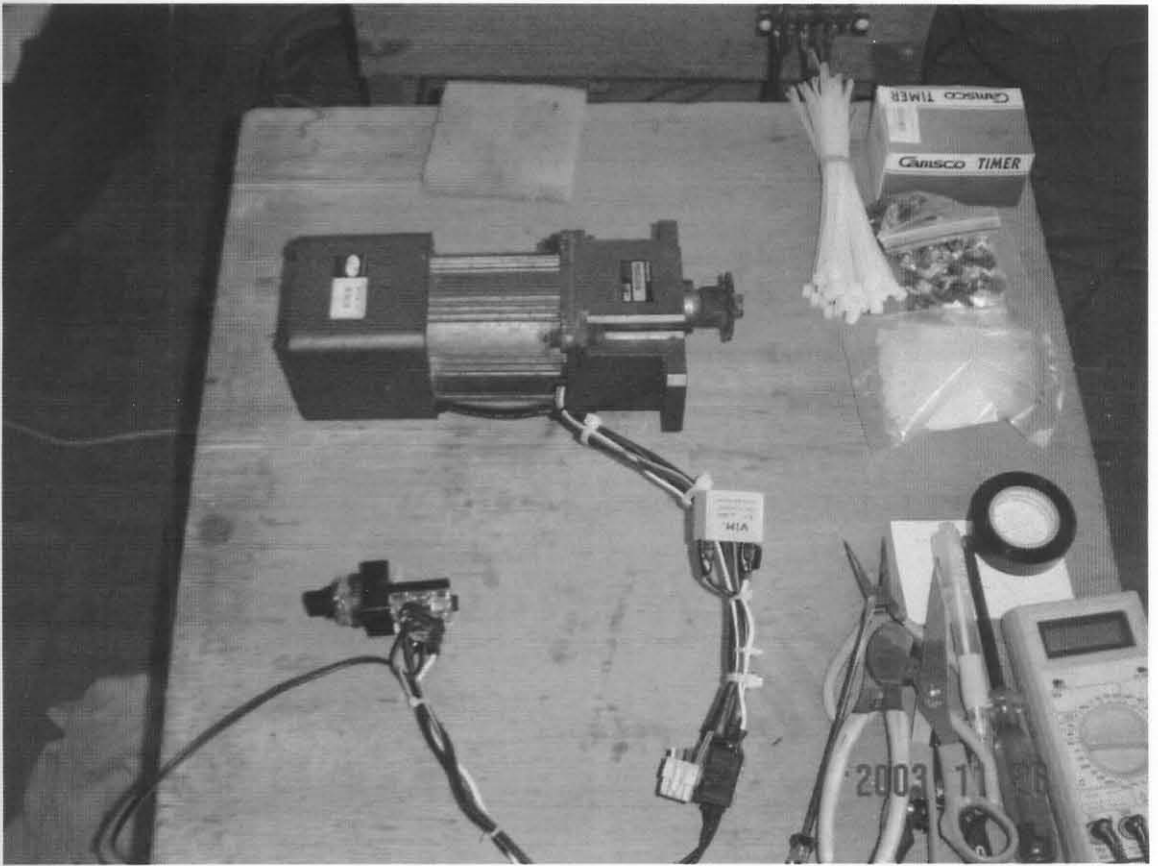
รูปที่ 16 แสดงมอเตอร์ที่ครอบ (Panasonic Model 91C90GD4W ประกอบชุดเฟืองทด Model M9GC20B) หนึ่งในสองตัว ขณะทดสอบการหมุน
