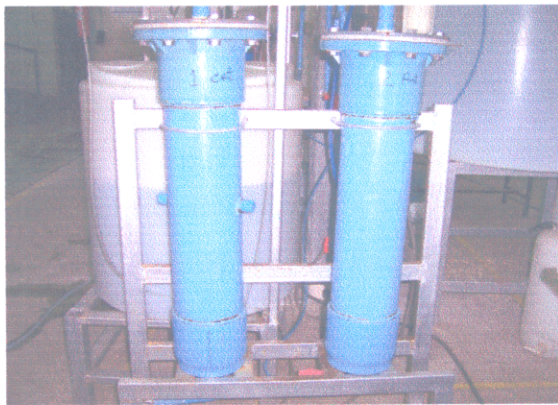
ภาพประกอบที่ 26 คอลัมน์บรรจุ cation resin และ anion resin
