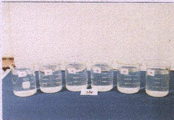
ภาพประกอบ 14 การลดความเข้มข้นของสารหนู โดยใช้สารส้มที่ความเข้มข้น 0, 10, 15, 20, 25 และ 30 มิลลิกรัมต่อลิตร (โดยปรับ pH)
