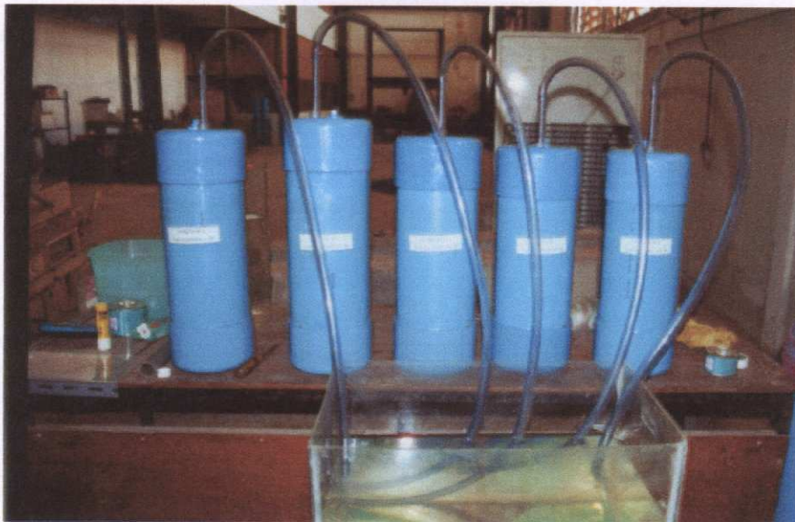
ภาพที่ 11 แสดงถังหมักไร้อากาศแบบไม่มีใบกวนและการต่อท่อก๊าซไปไว้ในถังน้ำเพื่อระบายก๊าซ สำหรับระยะเวลาหมัก 5, 10, 15, 25 และ 35 วัน
