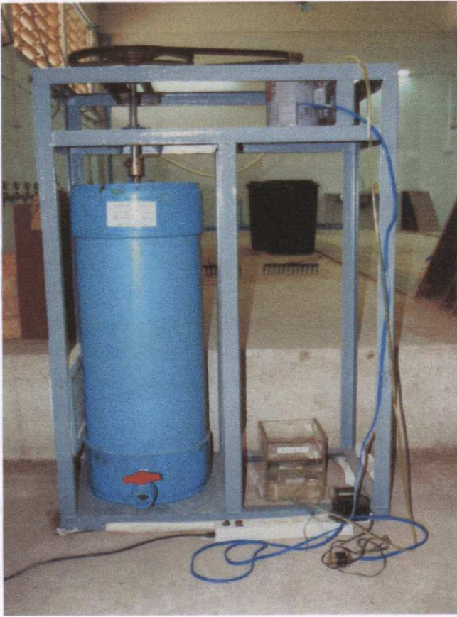
ภาพที่ 12 แสดงถังหมักไร้อากาศแบบมีใบกวนและการต่อท่อก๊าซไปยังเครื่องวัดปริมาณก๊าซอัตโนมัติ มีระยะเวลาหมัก 30 วัน
