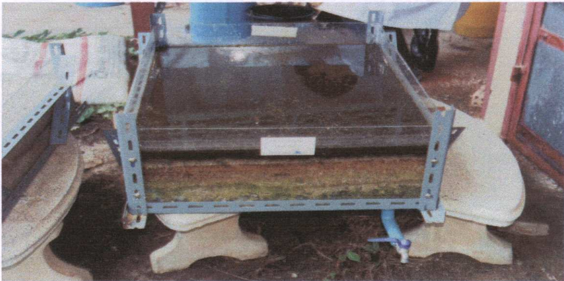
ภาพที่ 33 แสดงลักษณะของสิ่งปฏิกูลที่ครบระยะเวลาการหมักเมื่อเทลงบนลานทรายตากตะกอน
