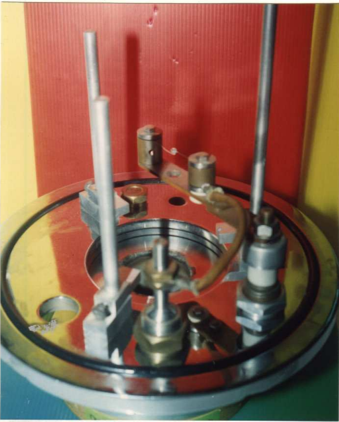
รูปที่ 6 เสายึดจับชิ้นงานสารรองรับ 3 เส้น
