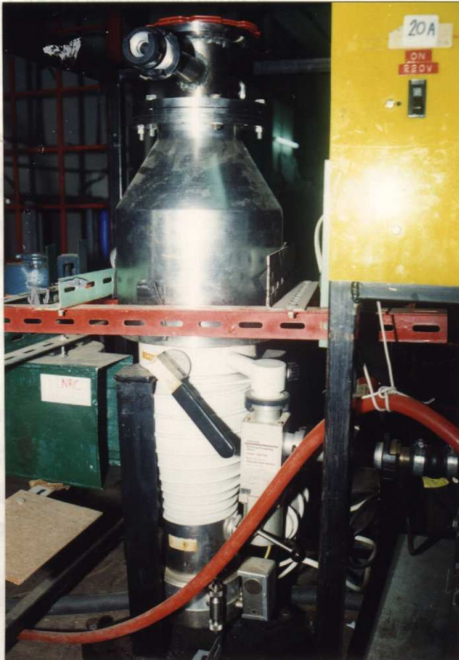
รูปที่ 1 โครงสร้างส่วนประกอบของปั๊มไอฟุ้งกระจาย รุ่น Mk2 ของบริษัท Edwards ตัวจับไอน้ำ และเพลทฐานของภาชนะสุญญากาศ
