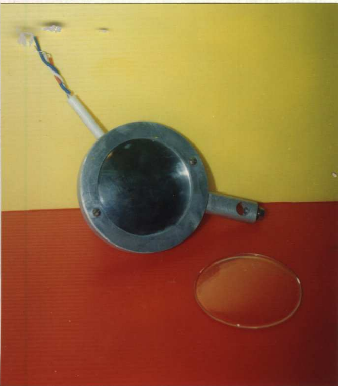
รูปที่ 7 เพลทยึดจับชิ้นงานสารรองรับประเภทกระจกรูปทรงวงกลม
