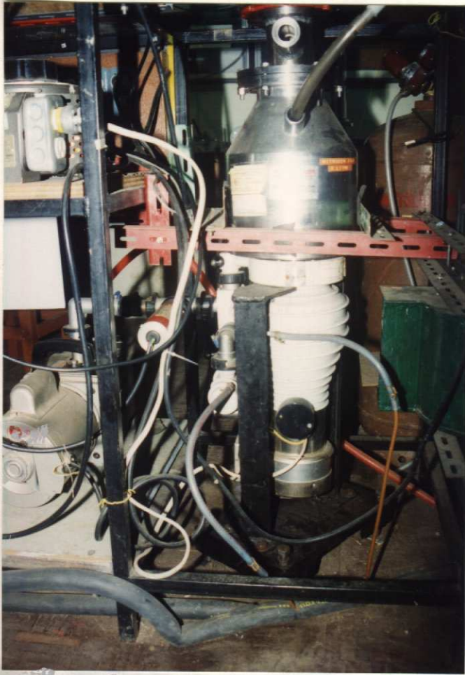
รูปที่ 13 ระบบความดันสุญญากาศ ประกอบด้วยปั๊มไอน้ำมันฟุ้งกระจายและปั๊มกลโรตารี
