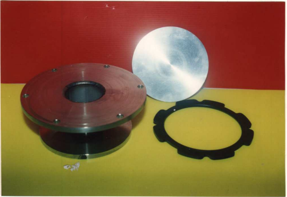
รูปที่ 2 ด้านใต้ของเพลทฐานที่ทำเป็นบารองรับยางโอริงค์ ที่เป็นจุดเชื่อมต่อกับระบบสุญญากาศปั๊มไอน้ำมันฟุ้งกระจาย
