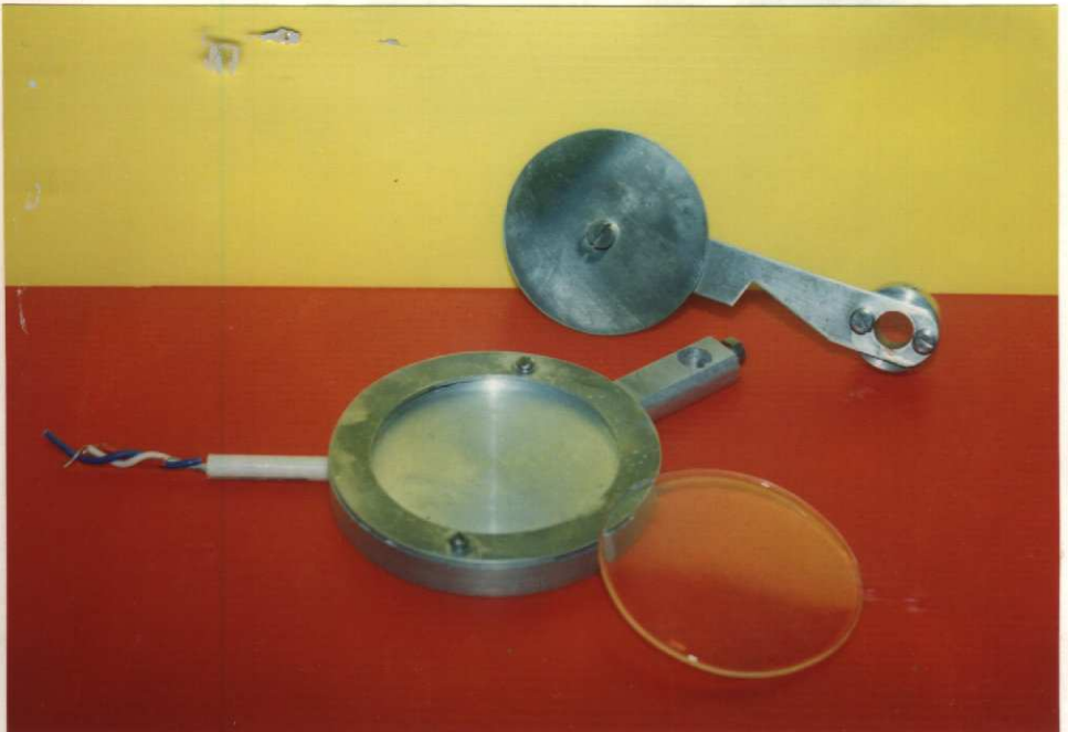
รูปที่ 5 ข้อต่อสุญญากาศและระบบปิด-เปิด กำบังไอสารระเหิด
