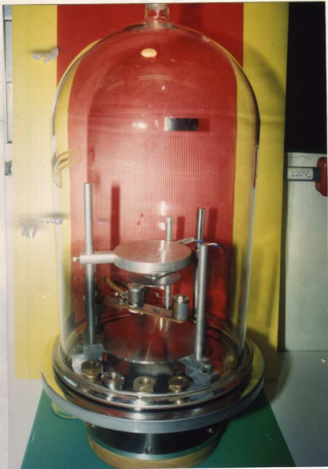
รูปที่ 9 อุปกรณ์ภาชนะสุญญากาศสำหรับการเคลือบผิวแบบระเหิดสารภายใต้สุญญากาศ
