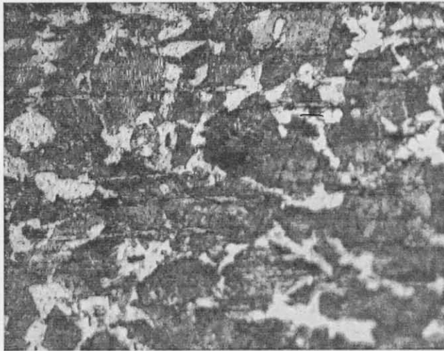
รูปที่ 18 ลักษณะโครงสร้างเฟอร์ไรท์(สีขาว) + เพียไลท์(สีเข้ม)ของเหล็ก 0.4%C ก่อนอบชุบ
