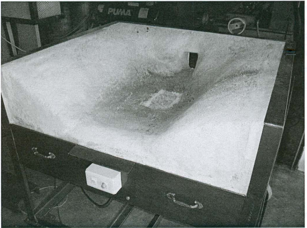
รูปที่ 13 เตาเผาเหล็กอุณหภูมิสูงที่ประกอบส่วนต่าง ๆ เสร็จแล้ว
