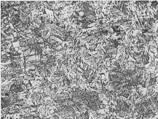
รูปที่ 22 โครงสร้างมาร์เทนไซต์ + เพียไลต์ ที่ระยะ 15 ม.ม.จากปลายมีด(200X) 32 HRC 4% Nitral etch.
