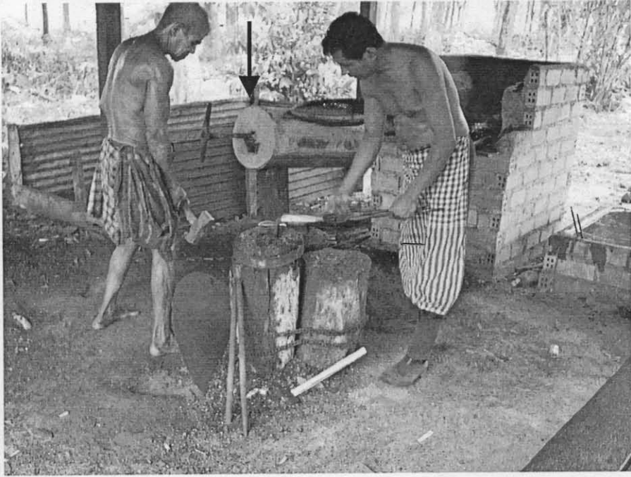
รูปที่ 12 การตีเหล็กแบบเดิม ลักษณะของสุมลมและเตาเผาที่ใช้
