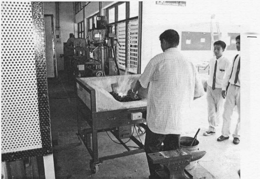
รูปที่ 16 ทดลองเผาเหล็กด้วยถ่านชนิดต่าง ๆ เพื่อหาประสิทธิภาพเตาและการสิ้นเปลืองถ่าน
