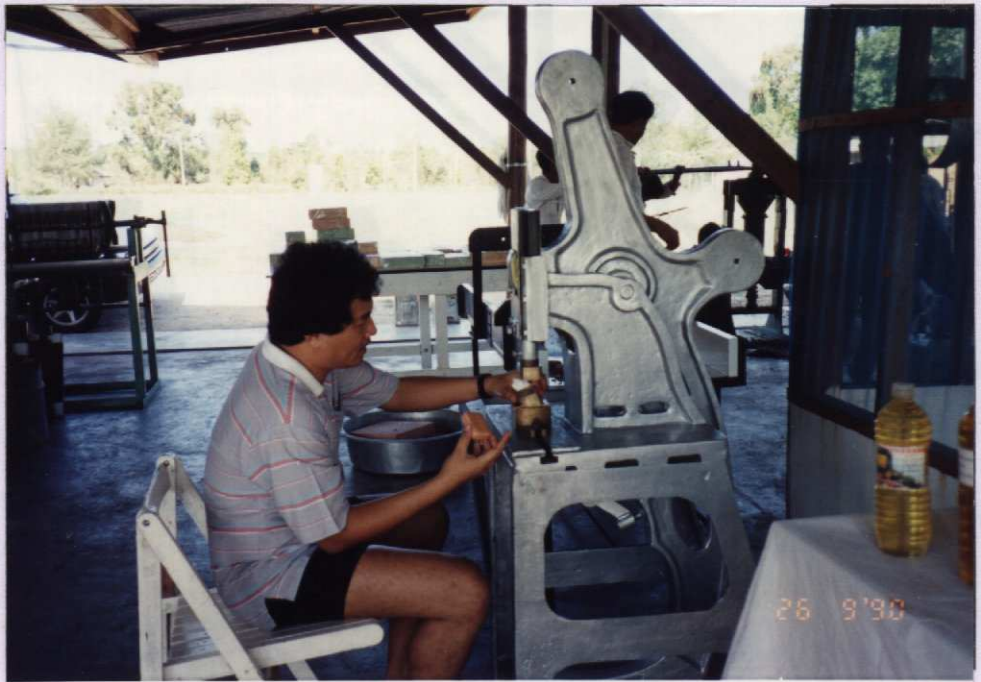
รูปที่ 4.8 เครื่องบั่นสบู่เป็นก้อน
