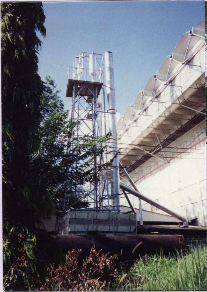
รูปที่ 3.16 ทอสูญญากาศบารอเมตริก คอนเดนเซอร์ และ Booster
