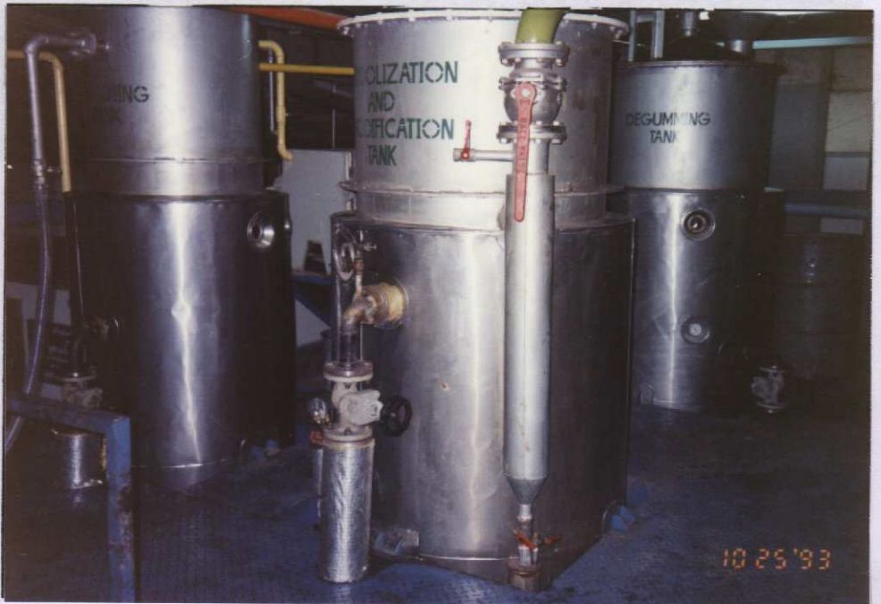
รูปที่ 3.8 ถังดีท็อกซ์ ฟอกสี และดูดกลืน
