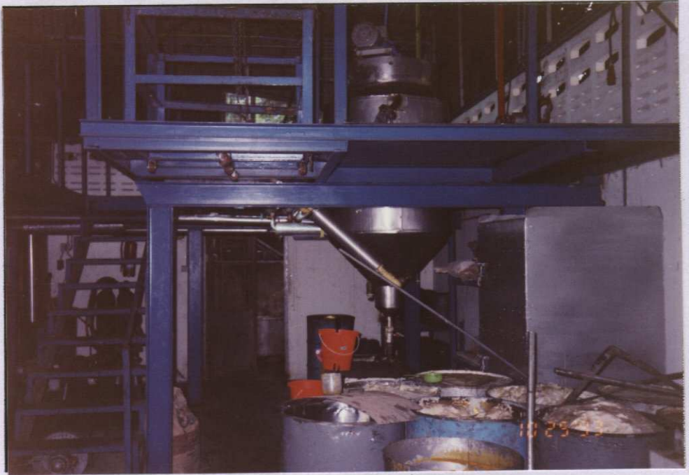
รูปที่ 3.9 ถังละลายไซ และถังต้มสุบู่
