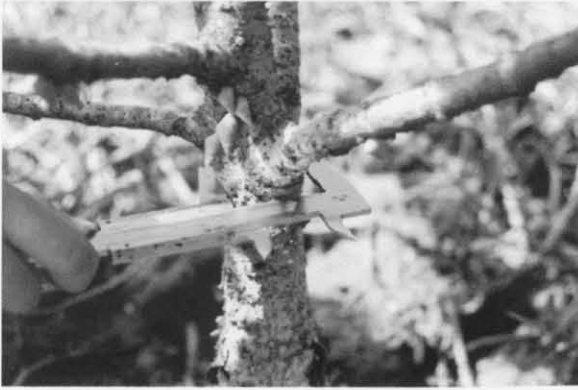
รูปที่ 3 การวัดขนาดเส้นผ่าศูนย์กลางโดย ใช้คาลิปเปอร์
