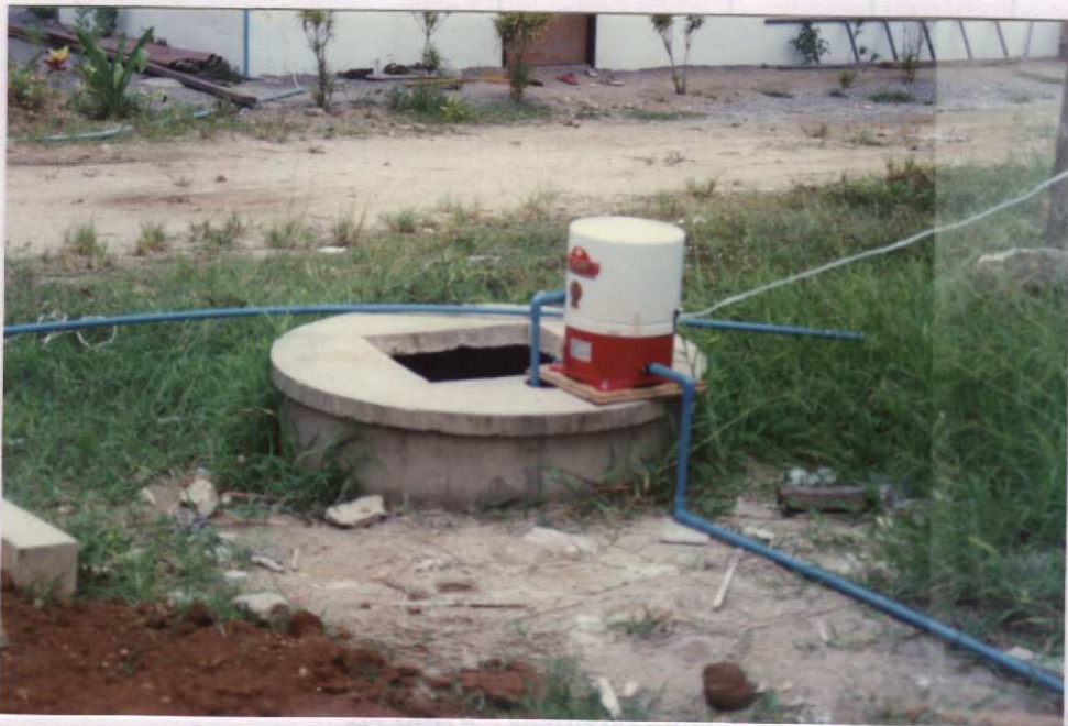
รูปที่ 3.14 จุดเก็บตัวอย่างที่ 3 บ่อน้ำตื้น ลึกประมาณ 6 เมตร ระดับน้ำใต้ดินขณะเก็บ ตัวอย่างน้ำประมาณ 50 เซนติเมตร
