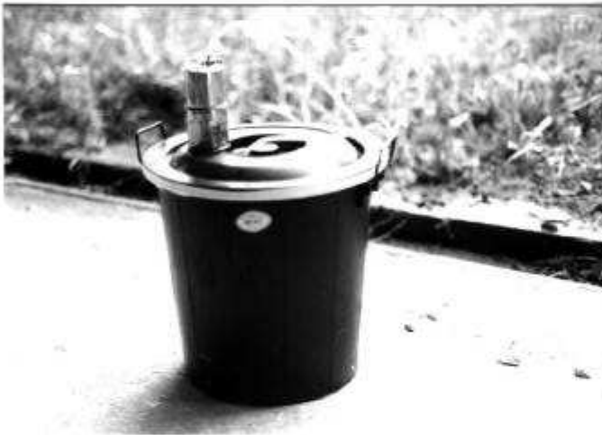
รูปที่ 8 การต่อท่อส่งก๊าซ Acetylene จากตะเกียงกำเนิดก๊าซไปยัง ถังบ่ม
