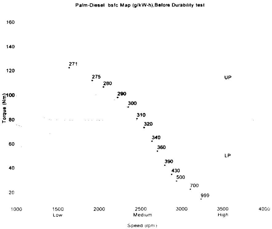
รูปที่ 73 แสดง performance map ของเครื่องยนต์เมื่อใช้น้ำมันดีเซลปาล์มดิบ
