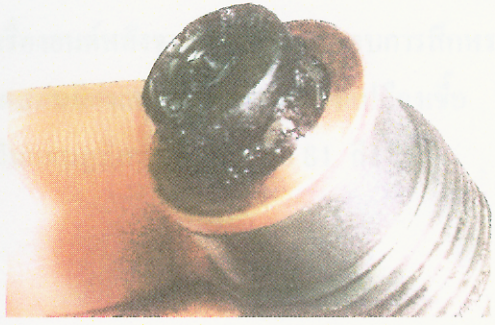
รูปที่ 78 แสดงลักษณะสเปรย์ที่เป็นเส้นไม่พุ่ง กระจายและคราบเขม่าที่ติดอยู่ที่หน้าหัวฉีด
