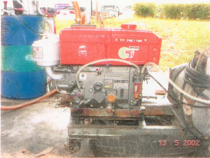
รูปที่ 1 เครื่องยนต์ที่ใช้ในการทดสอบโดยติดตั้งบนเรือประมงขนาดเล็ก
