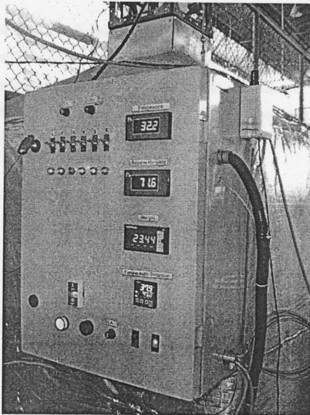
รูปที่ 3.25 ค่าปรับตั้งบนตู้ควบคุมอบแห้งยางแผ่นดิบ
