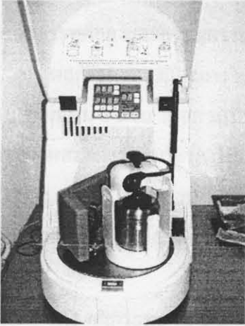
รูปที่ 4 แสดงอุปกรณ์ที่ใช้ในการวิจัย (ก) เครื่องบดผสมชนิดพลังงานสูง (ข) ชุดเตาอบควบคุมบรรยากาศอุณหภูมิสูง
