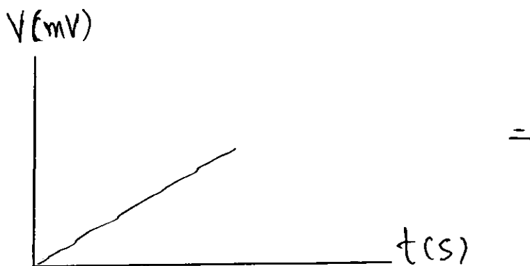
รูปที่ 4.1.2 ภาพบนจอคอมพิวเตอร์ที่แสดงแรงดันเทอร์โมอิเล็กทริกที่เปลี่ยนแปลงตามเวลาของสาร
